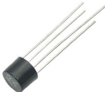
Figura 37: Puente rectificador 200V a 2 A
