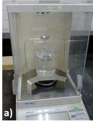
Fig. 22, Dispositivo para realizar las mediciones del peso de la muestra en aire y en agua.
