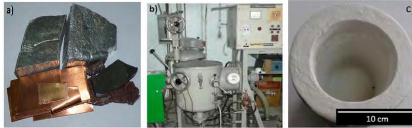
Fig. 18. Materias primas utilizadas para la fabricación de la aleación (a). Horno de inducción con cámara de vacío (b). Crisol de grafito recubierto de nitruro de boro (c).
