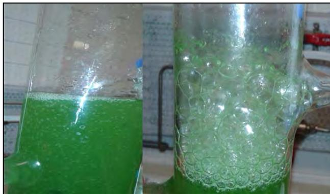
Figura 11 Comparación del proceso de flotación con aire (a) y con ozono (b) respectivamente durante la recuperación de biomasa de microalga
