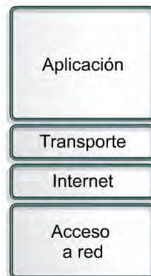
Figura 1.14: Capas del Modelo de Referencia TCP/IP
