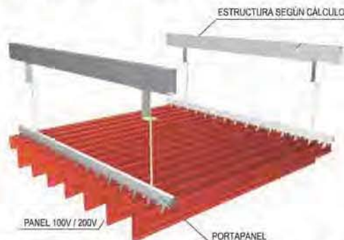
Fig. 14.4 Detalle de montaje sobre los portapaneles anclados a la estructura.
