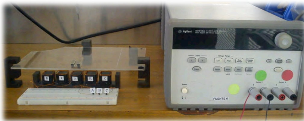
Figura 3.26 Prueba de fases con fuente
