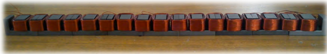
Figura 4.8 Tren de ferritas con bobinas
