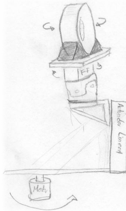
Figura 3.3 Movimientos de la llanta (actuador)
