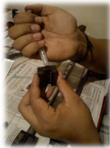
Figura 4.13 Lubricación rodamientos lineales
