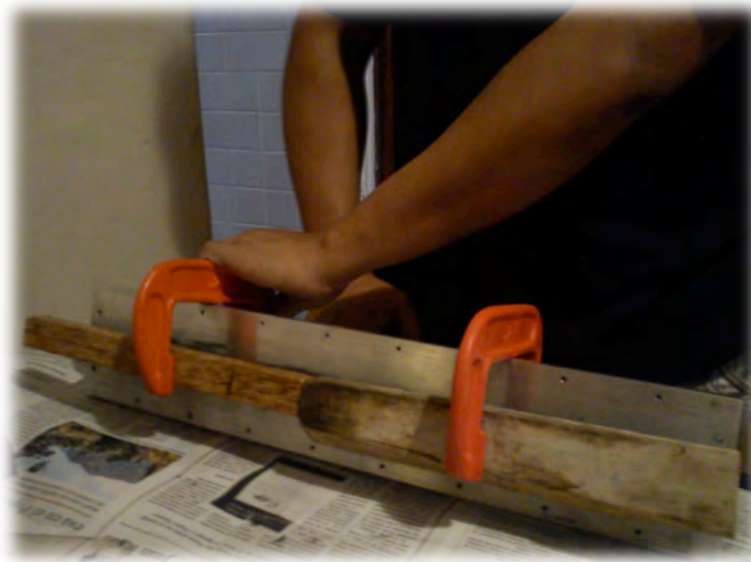
Figura 4.11 Fijación del tren de ferritas
