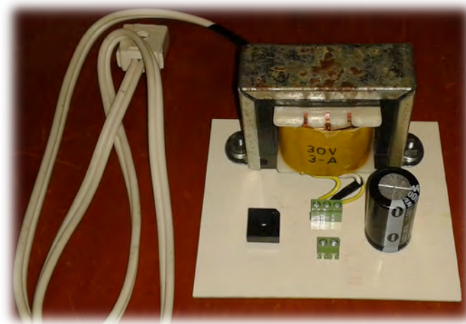
Figura 4.17 PCB fuente 40 VCD 4 A
