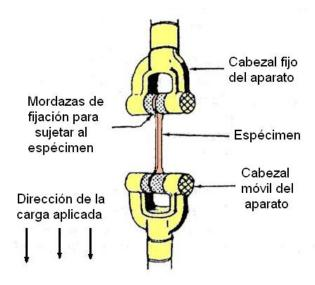
Figura 23. Esquema representativo de un ensayo de tracción.
