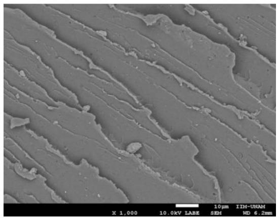
Figura 85. Micrografía de policarbonato reciclado sin hidrólisis a 1,000 aumentos.
