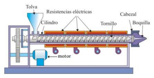
Figura 13. Esquema de una extrusora de husillo simple.
