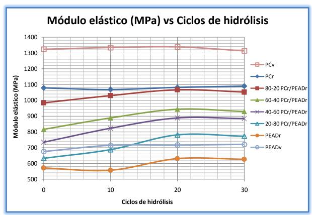
Figura 46. Variación del módulo en función de la mezcla PCr/PEADr, de acuerdo a los ciclos de hidrólisis.
