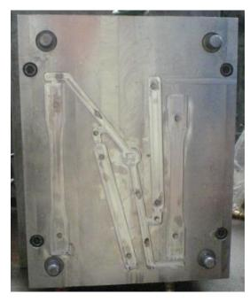
Figura 34. Molde normalizado ASTM-D638
