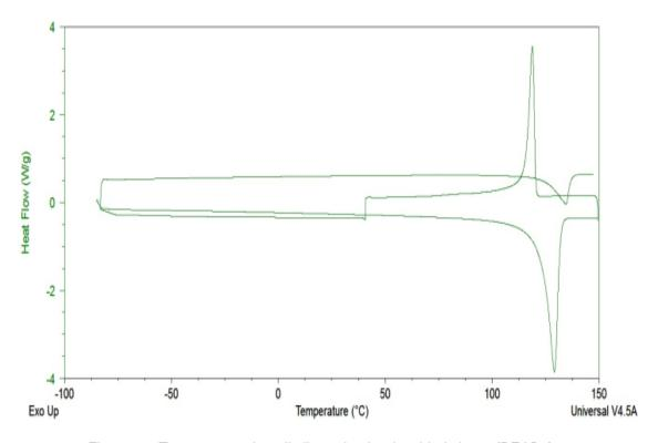
Figura 99. Termograma de polietileno de alta densidad virgen (PEADv).
