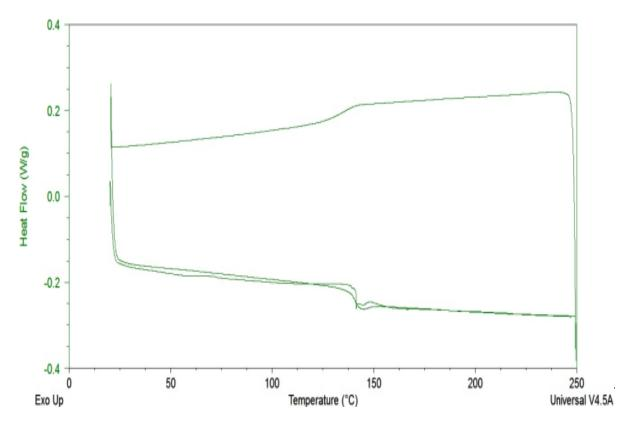
Figura 100. Termograma de policarbonato reciclado (PCr).
