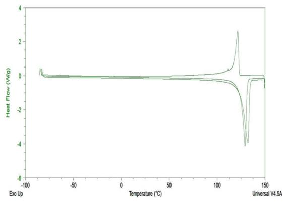
Figura 98. Termograma de polietileno de alta densidad reciclado (PEADr).
