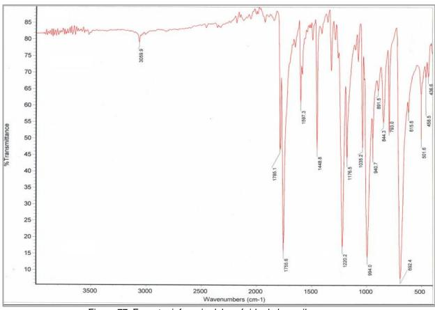
Figura 77. Espectro infrarrojo del peróxido de benzoilo
