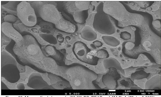
Figura 60. Micrografía de la mezcla (80-20) PCr/PEADr + 1.5M-BisA (75g) a 5,000X.
