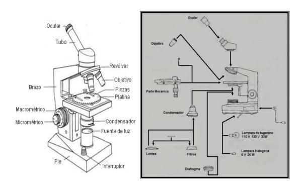
Figura 25. Esquema de microscopio óptico.
