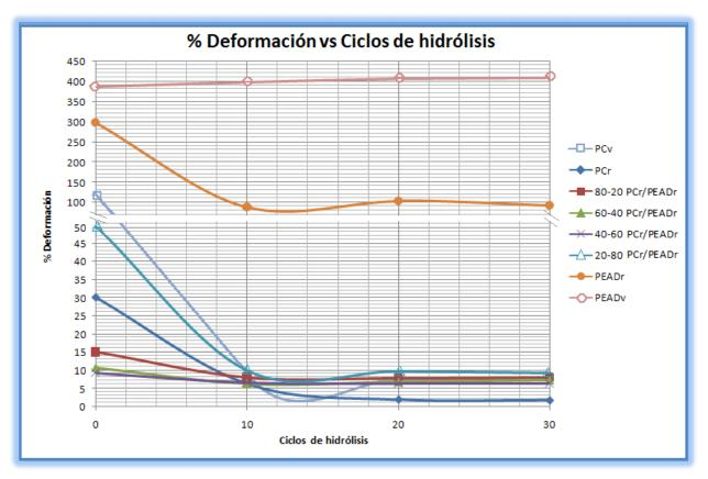
Figura 47. Deformación (%) de las muestras PCv, PCr, PEADv, PEADr y sus mezclas en función de los ciclos de hidrólisis.
