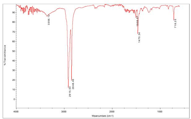
Figura 74. Espectro infrarrojo del compatibilizante 6M-Bis A
