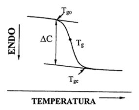
Figura 30. Representación esquemática de un termograma obtenido por DSC correspondiente a una transición de segundo orden como la transición vítrea ( $Tg_o$ = temperatura de inicio de la transición vítrea; Tg= temperatura del punto medio;  $Tg_c$ = temperatura final de la transición), [Martínez N. *et al*, 1998].
