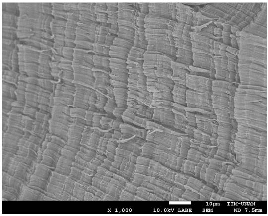
Figura 87. Micrografía de polietileno de alta densidad virgen sin hidrólisis a 1,000 aumentos.
