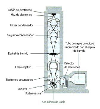
Figura 26. Esquema de un microscopio electrónico de barrido.
