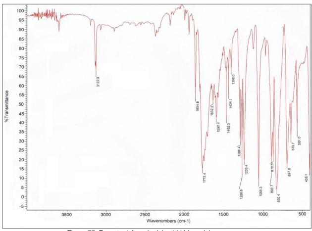
Figura 75. Espectro infrarrojo del anhídrido maleico
