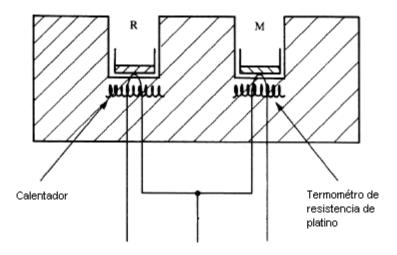
Figura 28. Esquema de un aparato de DSC, [Albella, J.M. et al, 1993].
