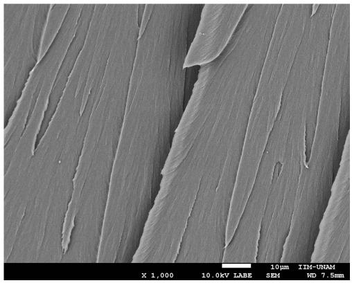
Figura 81. Micrografía de policarbonato virgen sin hidrólisis a 1,000 aumentos.
