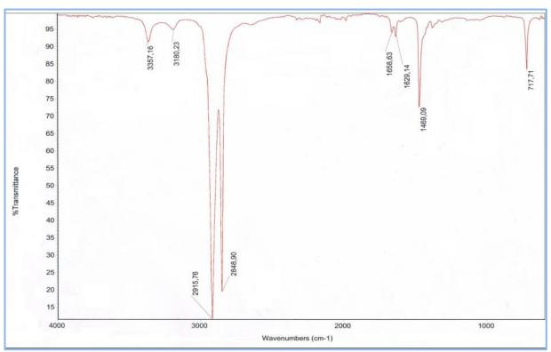
Figura 78. Espectro infrarrojo de polietileno de baja densidad
