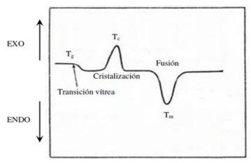
Figura 31. Termograma obtenido con DSC de un polímero semicristalino, [Cornement, 2011].
