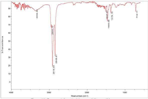
Figura 73. Espectro infrarrojo del compatibilizante 6M.
