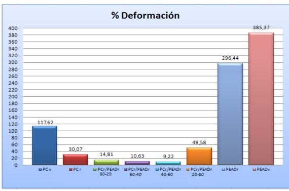
Figura 44. Variación del % de deformación en función del PCr, PEADr y sus mezclas.
