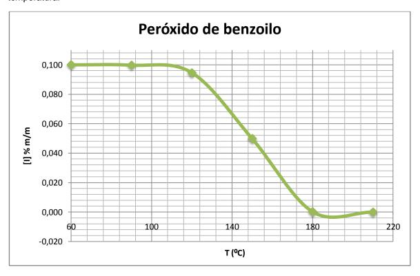
Figura 105. Gráfica de concentración de peróxido de benzoilo con respecto a la temperatura.
