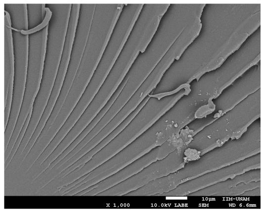
Figura 83. Micrografía de policarbonato virgen con 30 ciclos de hidrólisis a 1,000 aumentos.
