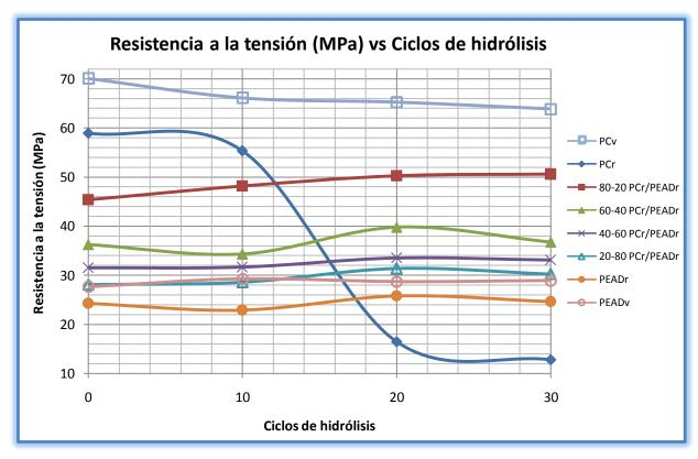
Figura 45. Variación de la resistencia a la tensión en función de las mezclas PCr/PEADr, de acuerdo a los ciclos de hidrólisis.
