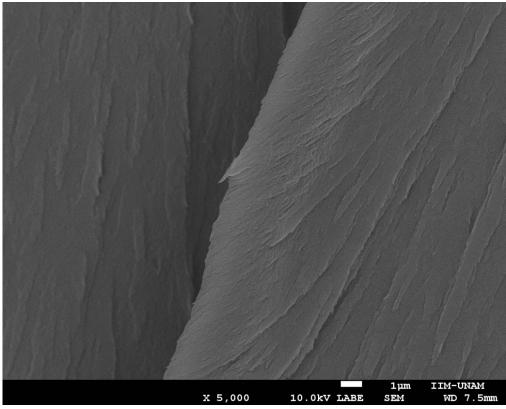
Figura 82. Micrografía de policarbonato virgen sin hidrólisis a 5,000 aumentos.
