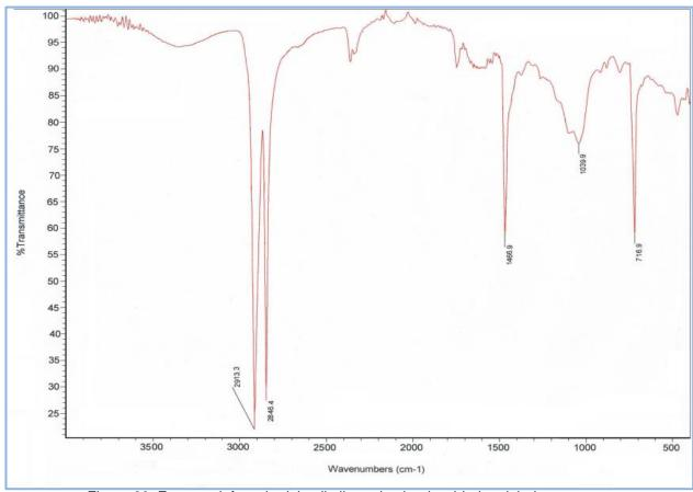
Figura 80. Espectro infrarrojo del polietileno de alta densidad reciclado
