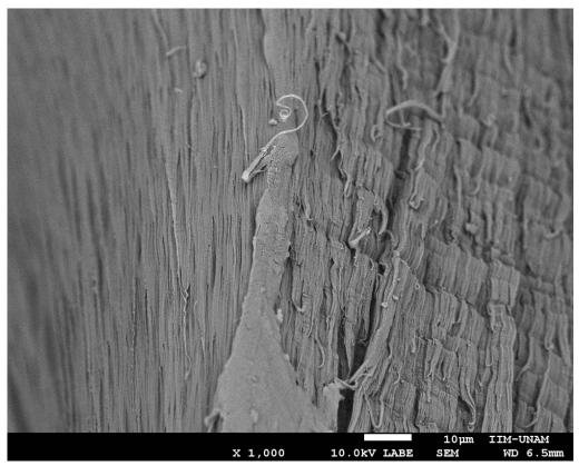
Figura 89. Micrografía de polietileno de alta densidad virgen con 30 ciclos de hidrólisis a 1,000 aumentos.
