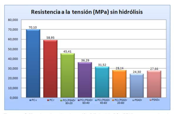
Figura 42. Gráfica de resistencia a la tensión (MPa) del PCr, PEADr y sus mezclas sin hidrólisis.
