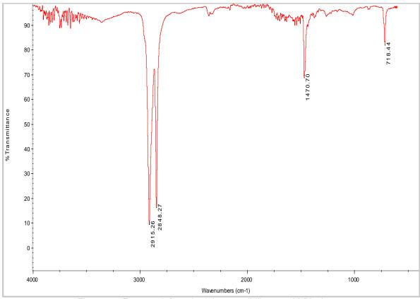
Figura 72. Espectro infrarrojo del compatibilizante 3M-Bis A
