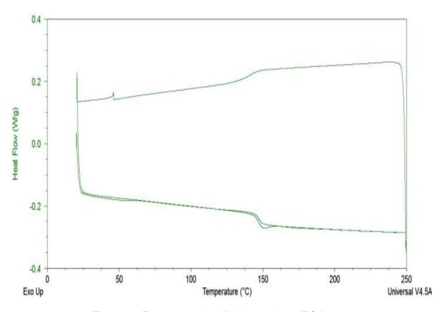
Figura 101. Termograma de policarbonato virgen (PCv).
