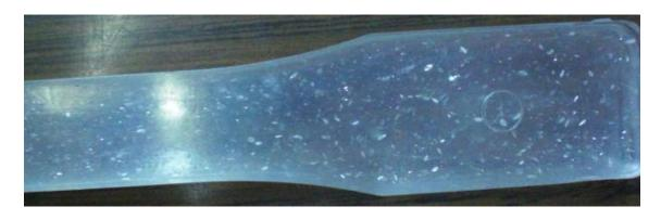
Figura 93. Probeta de policarbonato virgen con 20 ciclos de hidrólisis
