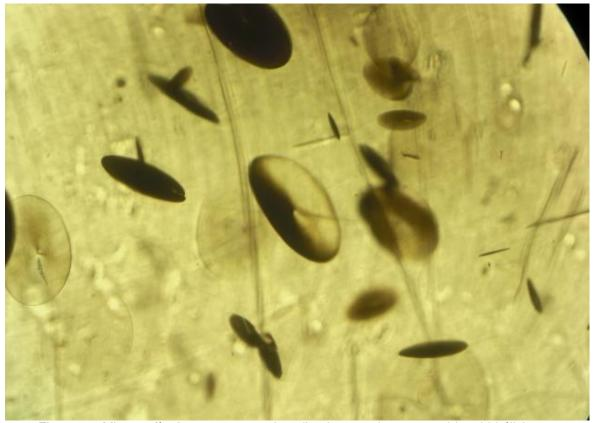
Figura 95. Micrografía de una muestra de policarbonato virgen sometida a hidrólisis.
