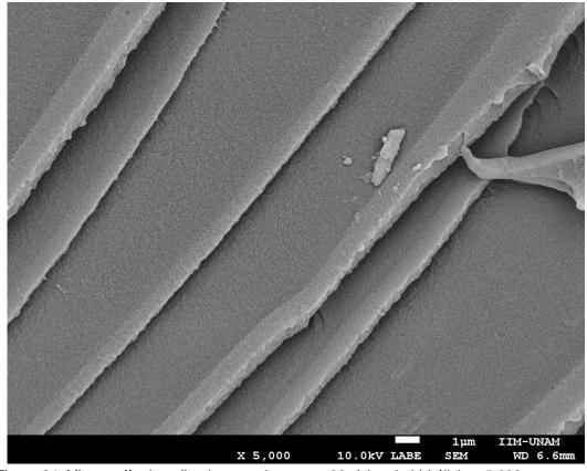
Figura 84. Micrografía de policarbonato virgen con 30 ciclos de hidrólisis a 5,000 aumentos.
