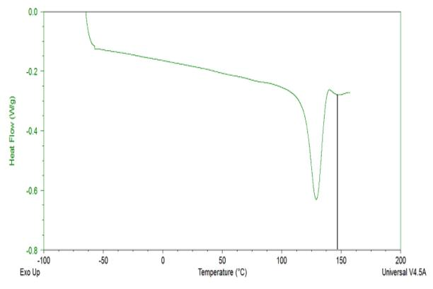
Figura 103. Termograma de una mezcla inmiscible de (80-20) PCr/PEADr + 1.5M-BisA (150g).
