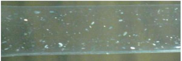
Figura 67. Acercamiento de una probeta de policarbonato con 30 ciclos hidrólisis.
