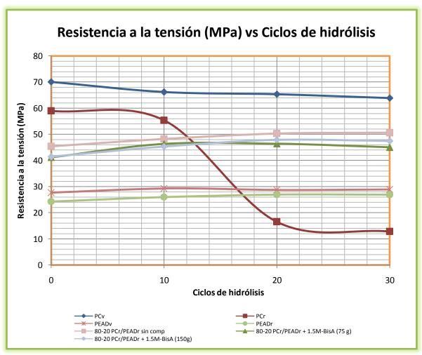
Figura 49. Resistencia a la tensión (MPa) vs ciclos de hidrólisis.
