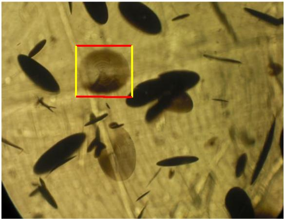
Figura 97. Apreciación de anillos concéntricos que dan lugar a la microcavidad.
