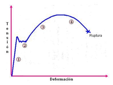
Figura 24. Diagrama tensión-deformación de un material dúctil, [D. J. Chacón, J. E. Huerfano y M. C. Escalante., 2009].
