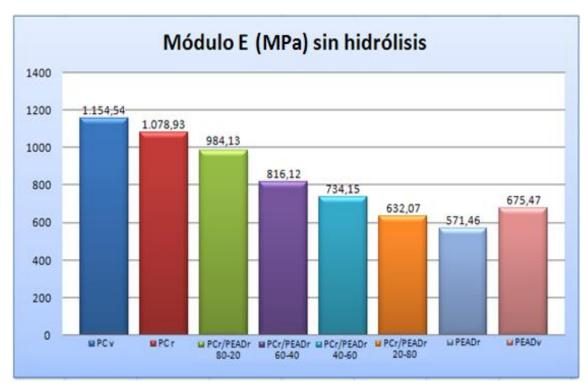
Figura 43. Variación del módulo elástico del PCr, PEADr y sus mezclas sin hidrólisis.
