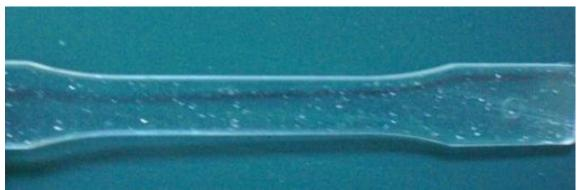
Figura 65. Probeta de policarbonato virgen expuesta a 10 ciclos de hidrólisis.
