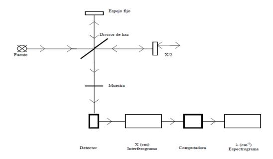
Figura 32. Diagrama simplificado de un espectrómetro por transformada de Fourier, [Gómez y Murillo, 2011].
