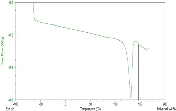
Figura 53. Termograma de una mezcla inmiscible de (80-20) PCr/PEADr en ausencia de compatibilizante.
