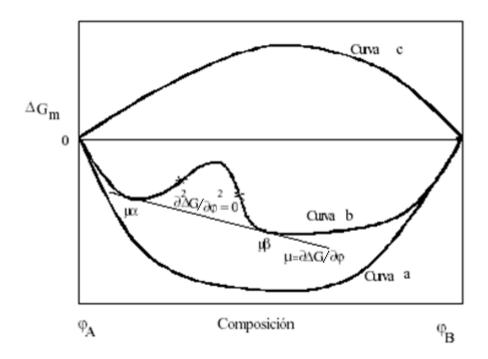
Figura 2. Evolución de  $\Delta G_m$  en función de la composición de la mezcla A+B, [A. García Loera, 2003]. Donde  $\Delta G_m$  es la energía libre de Gibbs de la mezcla,  $\phi$  es la composición de la mezcla y  $\mu$  es el potencial químico.
