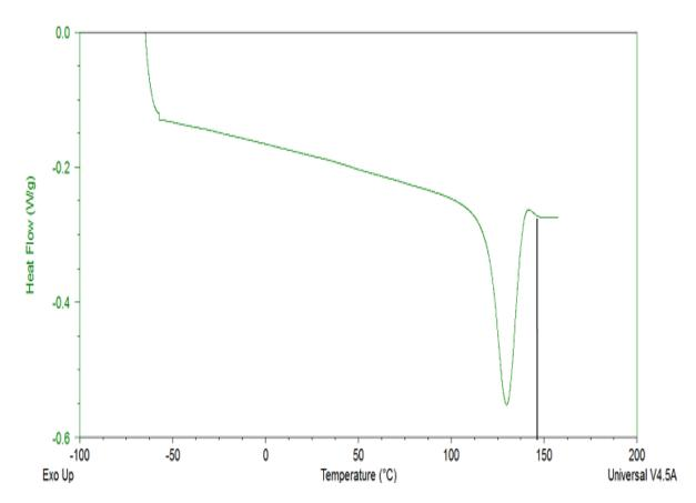
Figura 102. Termograma de una mezcla inmiscible de (80-20) PCr/PEADr + 1.5M-BisA (75g).
