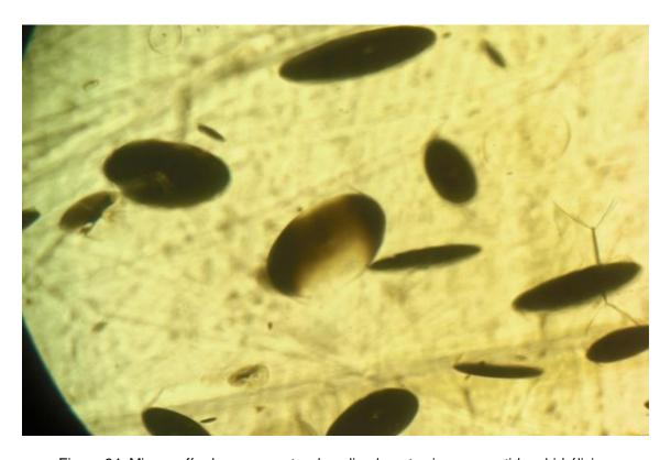
Figura 94. Micrografía de una muestra de policarbonato virgen sometida a hidrólisis.
