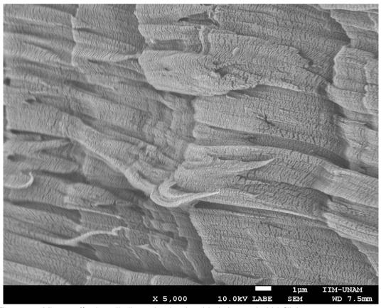
Figura 88. Micrografía de polietileno de alta densidad virgen sin hidrólisis a 5,000 aumentos.
