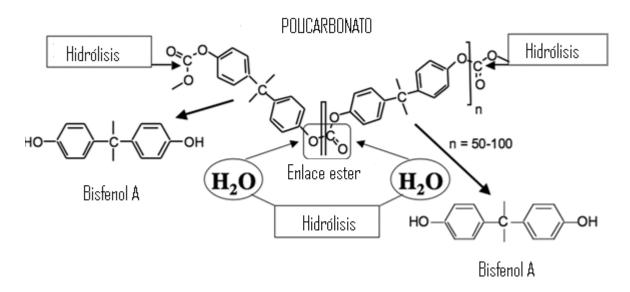
Figura 1. Diagrama que representa la hidrólisis del enlace éster, dicho enlace une las moléculas de bisfenol A, las cuales forman al policarbonato [Wade V. Welshons, 2006].
