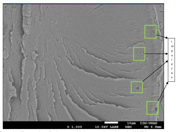
Figura 54. Muestra de policarbonato reciclado con treinta ciclos de hidrólisis, en esta micrografía se puede observar una superficie de fractura en varios planos.
