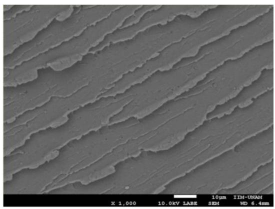
Figura 86. Micrografía de policarbonato reciclado sin hidrólisis a 1,000 aumentos.
