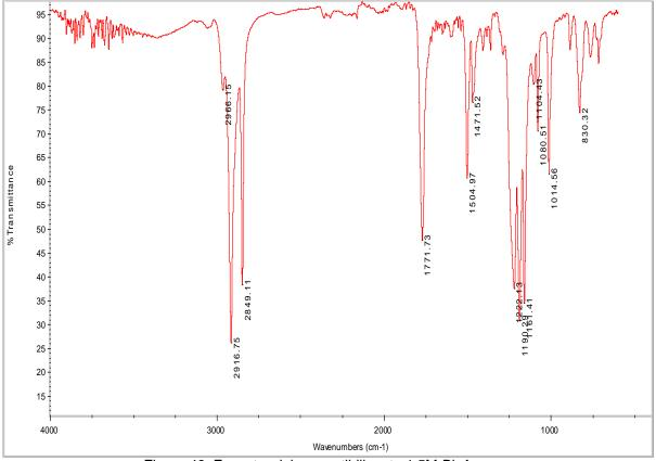
Figura 48. Espectro del compatibilizante 1.5M-BisA
