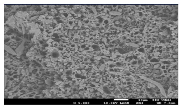
Figura 57. Micrografía de la mezcla (80-20) PCr/PEADr sin compatibilizante a 1,000X.
