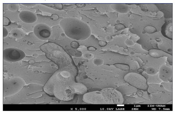
Figura 62. Micrografía de la mezcla (80-20) PCr/PEADr + 1.5M-BisA (150g) a 5,000X.
