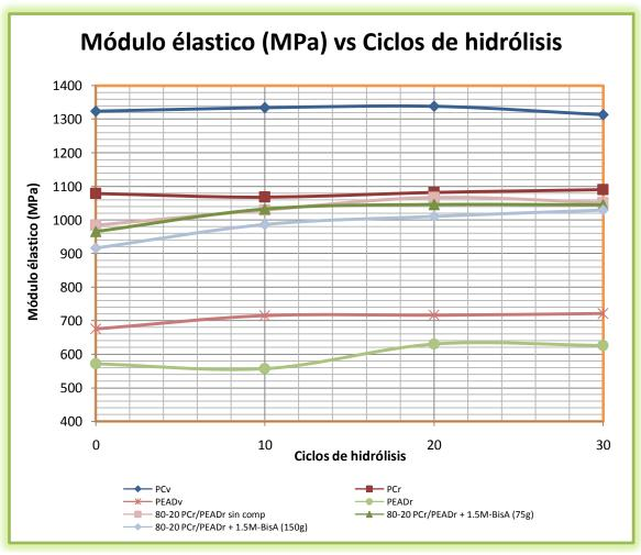
Figura 50. Módulo elástico vs ciclos de hidrólisis
