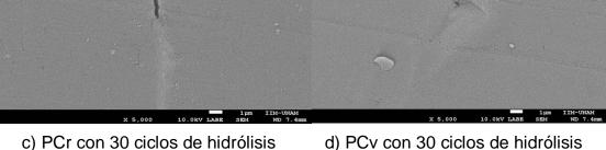
c) PCr con 30 ciclos de hidrólisis d) PCv con 30 ciclos de hidrólisis Figura 55. Micrografías tomadas a 5,000 aumentos, (a) PCr sin hidrólisis, (b) PCv sin hidrólisis, (c) PCr con 30 ciclos de hidrólisis y (d) PCv con 30 ciclos de hidrólisis.
