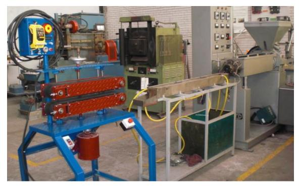
Figura 33. Extrusor de tornillo simple marca Nieto
