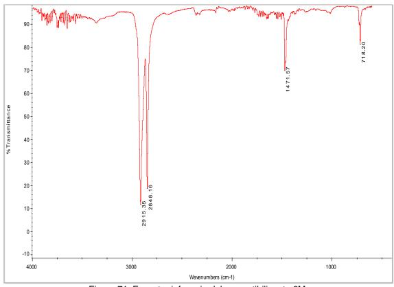
Figura 71. Espectro infrarrojo del compatibilizante 3M
