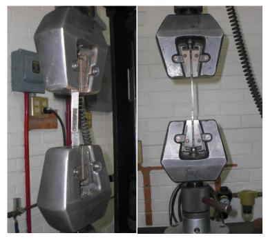
Figura 36. Ensayo de tensión.
