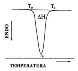
Figura 29. Representación esquemática de un termograma obtenido por DSC, el cual muestra una endoterma correspondiente a una transición de primer orden como la fusión (To=temperatura de inicio de transición; Tp= temperatura en el pico; Tc= temperatura final de la transición), [Martínez N., A. Grau, Chiralt B., y Fito M., 1998].
