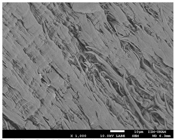
Figura 91. Micrografía de polietileno de alta densidad reciclado sin hidrólisis a 1,000 aumentos
