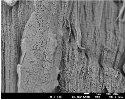
Figura 90. Micrografía de polietileno de alta densidad virgen con 30 ciclos de hidrólisis a 5,000 aumentos.
