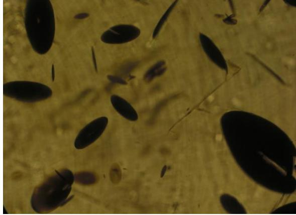
Figura 96. Microcavidades en una muestra de policarbonato virgen sometida a hidrólisis.
