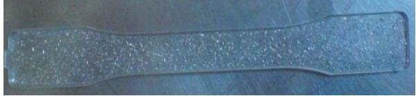
Figura 66. Probeta de policarbonato virgen sometida a 30 ciclos de hidrólisis.
