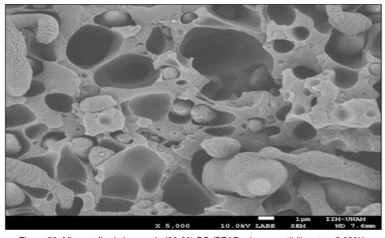
Figura 58. Micrografía de la mezcla (80-20) PCr/PEADr sin compatibilizante a 5,000X.
