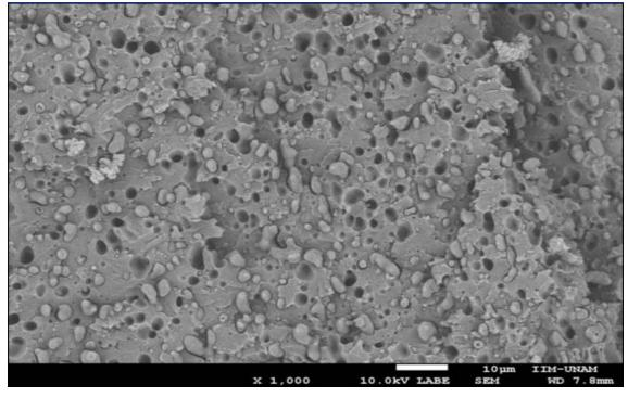
Figura 61. Micrografía de la mezcla (80-20) PCr/PEADr + 1.5M-BisA (150g) a 1,000X.
