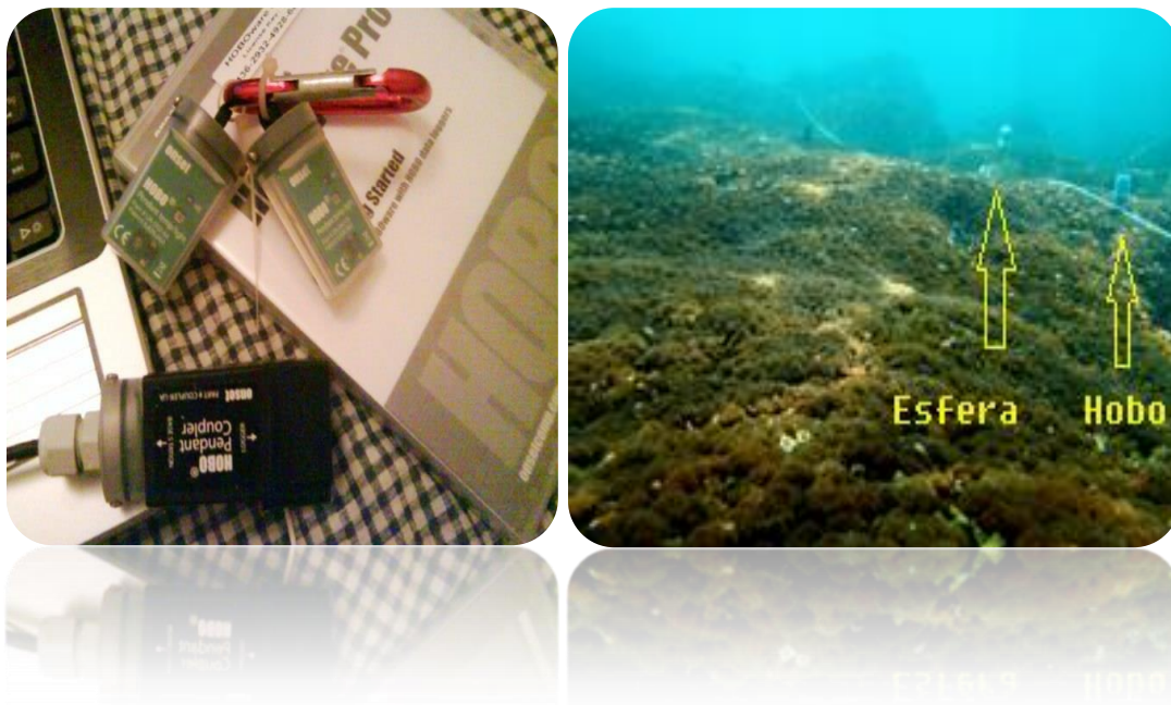
Figura. 4. Registradores HOBOS Pendant en gabinete (izquierda) y ubicación de HOBOS y esferas de escayola en el campo (derecha).
