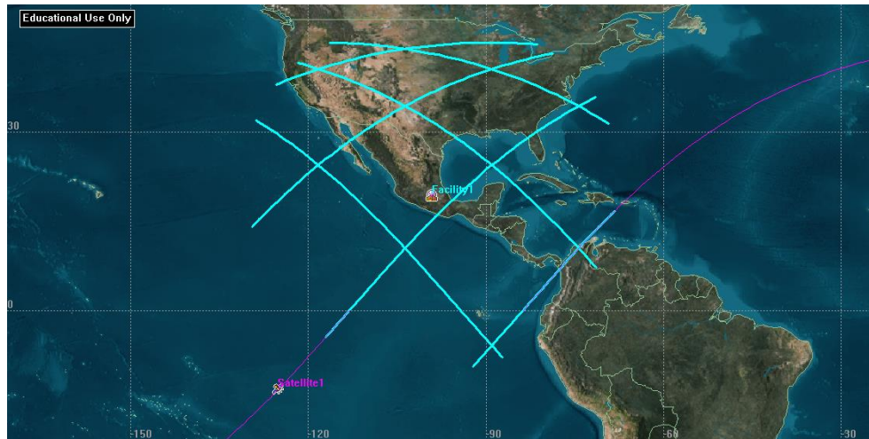
Fig. 6.34 Efecto en la cobertura de la estación terrena debido a la limitación establecida en el valor del RIP
