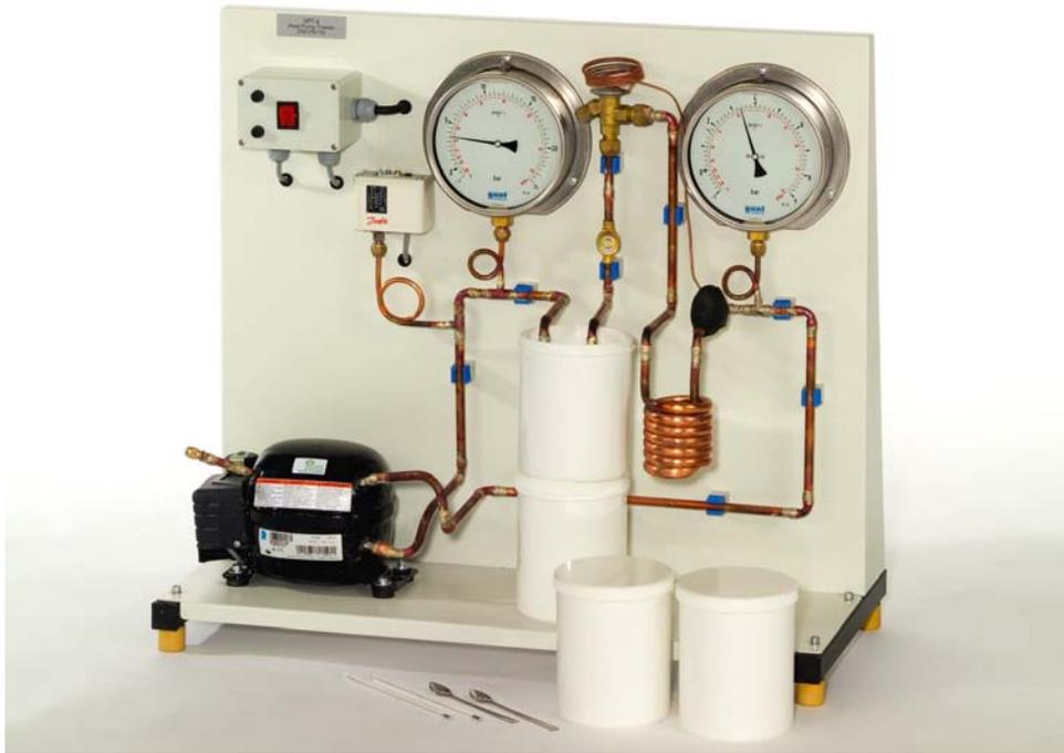
Figura 6. Circuito de refrigeración por compresión sencillo (*Gunt HAMBURG*).
