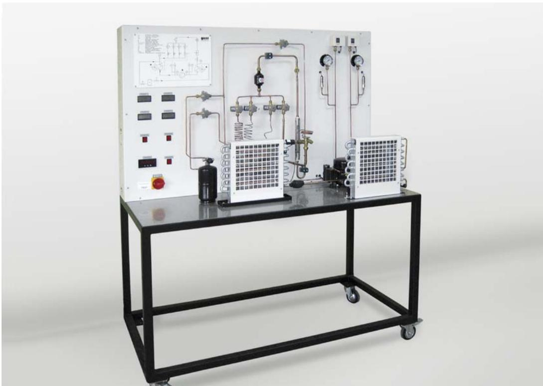
Figura 8. Instalación frigorífica de compresión (*Gunt HAMBURG*).
