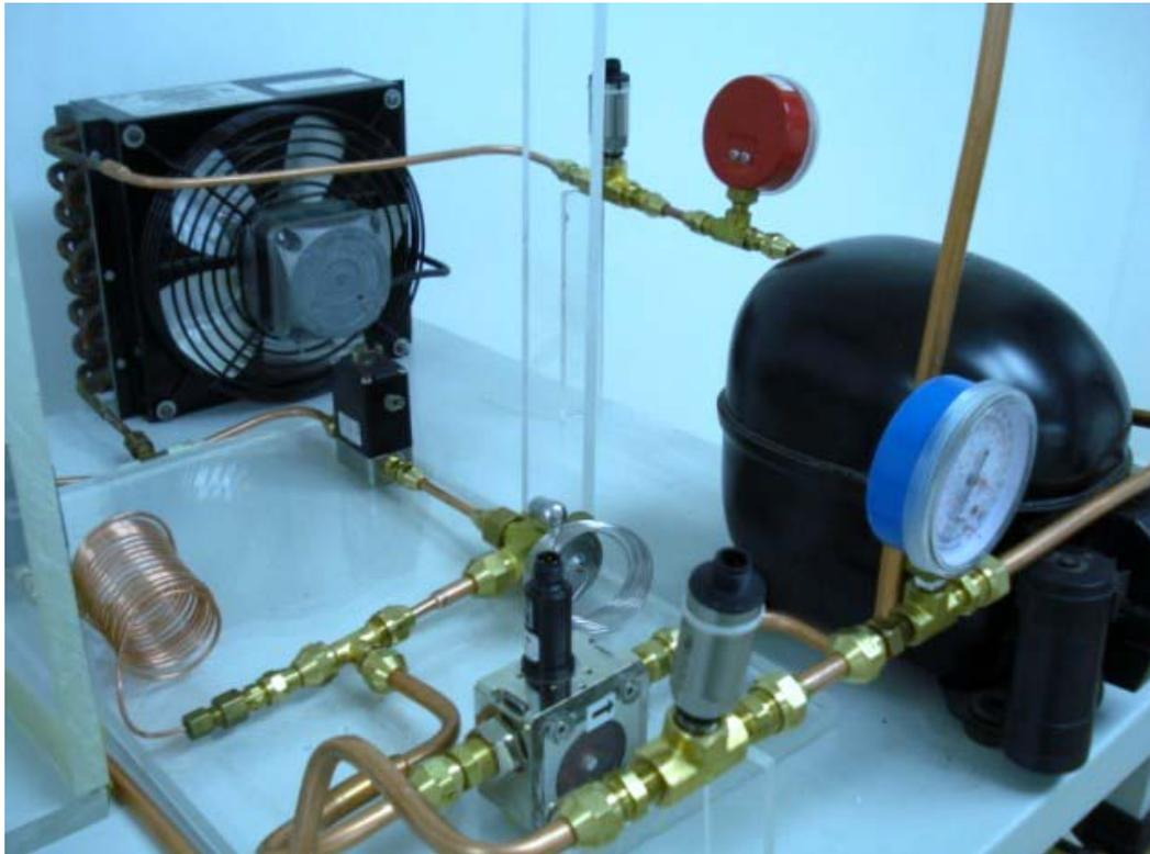
Figura 28. Arreglo de la instrumentación en el circuito de refrigeración.
