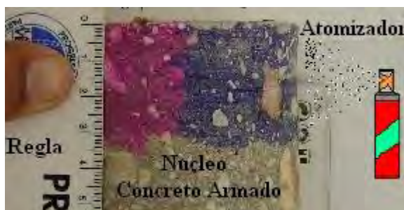
Figura 33. Aplicación de solución indicadora para determinación del avance del frente de carbonatación.
