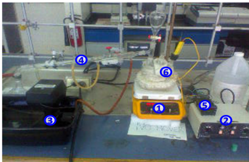
Figura 12. Configuración del equipo para la síntesis de alúmina por el método Sol-gel. (1) Parrilla de calentamiento con agitador magnético, (2) Regulador de corriente para la manta de calentamiento, (3) Bomba de agua, (4) Refrigerante de bolas, (5) Controlador de temperatura, (6) Matraz de tres bocas con manta de calentamiento.
