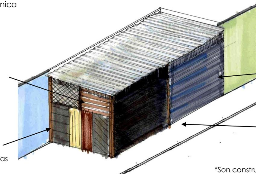
Los materiales empleados más usuales son láminas de asbesto o metálicas, y plásticos.
