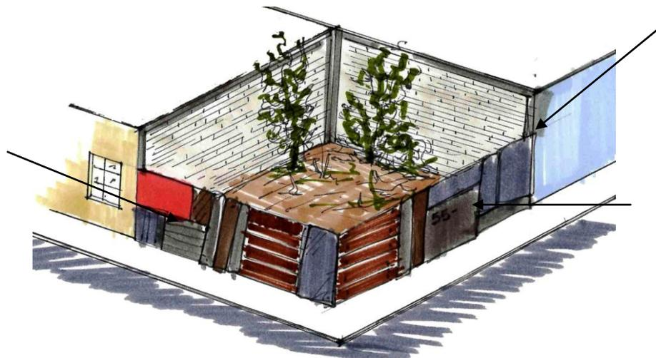
Los elementos resistentes de las construcciones contiguas son utilizados como apoyo principal para el armado de elementos de desecho.
