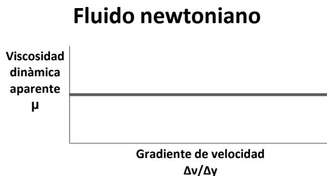
**Figura 1.2.** Viscosidad vs. Gradiente de velocidad.
