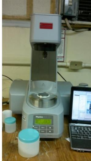
**Figura 3.4** Reómetro *Physica MCR 101*.
