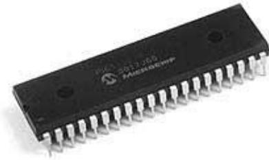
**Figura 1.13.** Imagen del PIC18F4550 (integrado de 40 pines).
