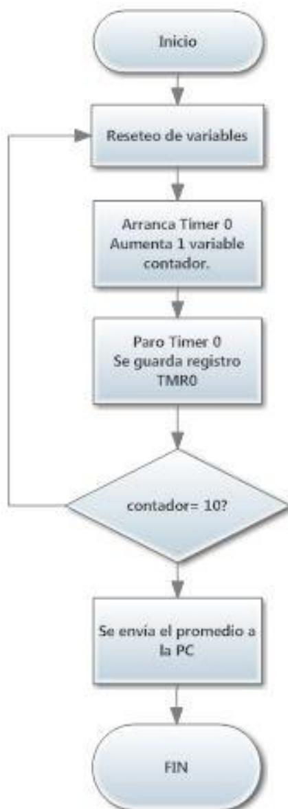
**Figura 2.14.** Diagrama de flujo del método de cuantificación del tiempo.
