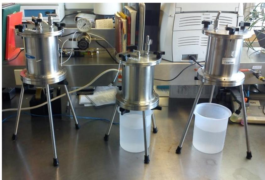
Figura 6.23 Cámara de extracción.
