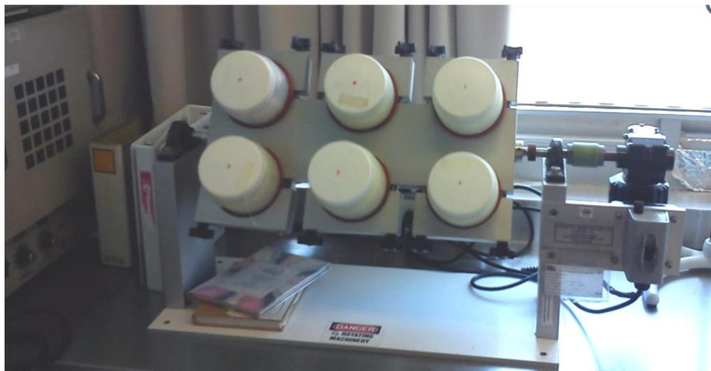
Figura 6.22 Equipo de extracción.
