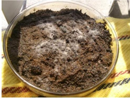
Figura 4.4 Presencia de hongos a las 72 h de saturación de la muestra inalterada.
