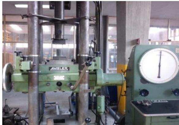
Figura 6.7 Ensayo de bloques a carga axial.
