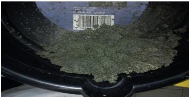
Figura 6.2 Reacción de jales con zeolita.
