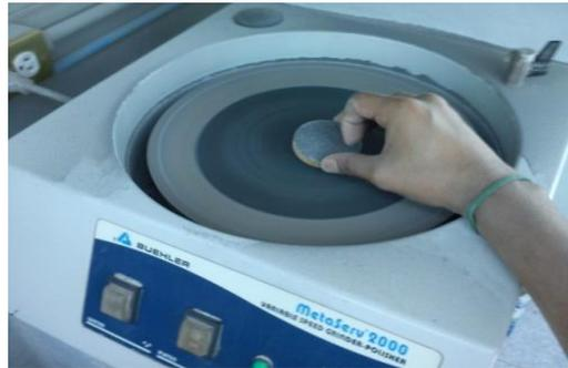
Figura 6.5 Lijado de muestras para uniformizar.
