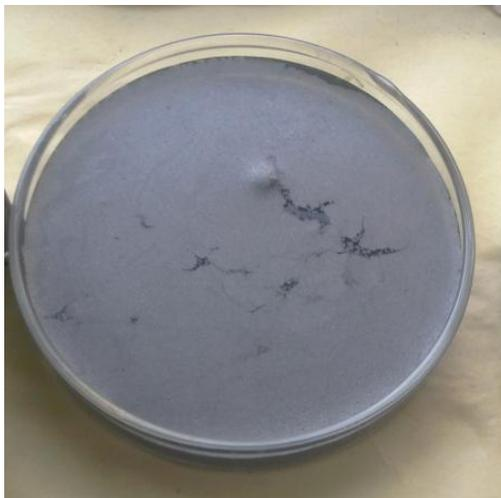
**Figura 4.9 Muestra saturada de jal.**
