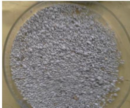
Figura 5.1 Zeolita de granulometría homogénea contenida en la malla 30.
