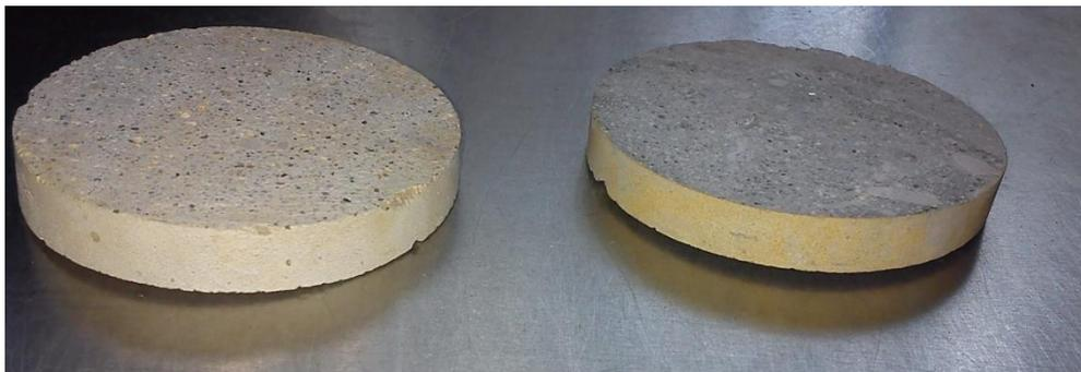
Figura 6.6 Cortes o lajas para ensayos.
