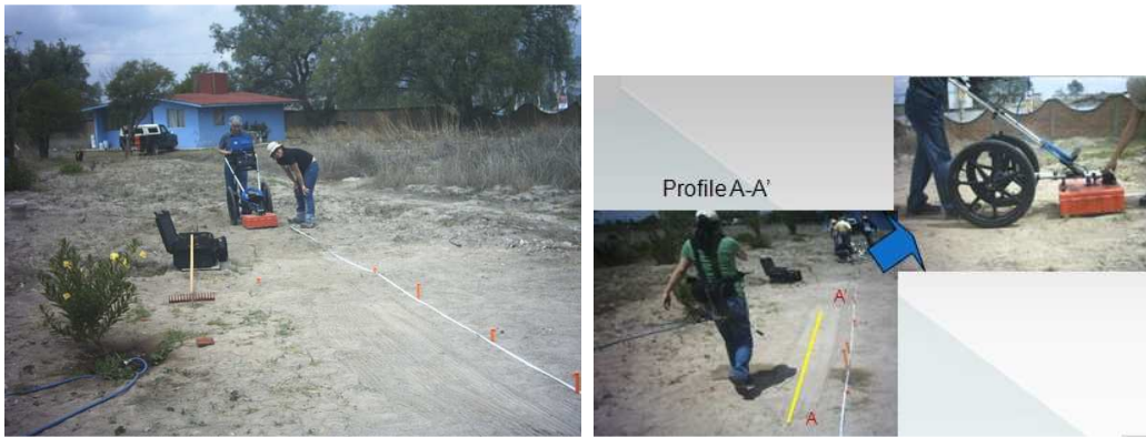
Figura 4.44.- Ubicación de la excavación donde se enterró el tambo metálico, en el predio, en donde se pasó el equipo de GPR y en el cual se obtuvo el perfil A-A' del radagrama real.
