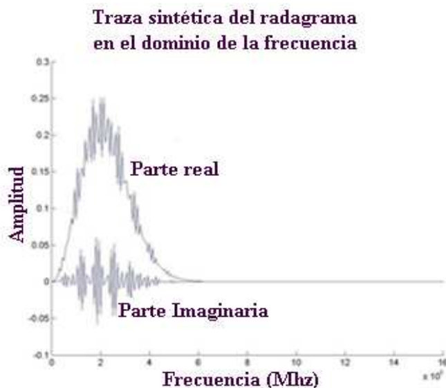
Figura 4.41.- La traza del radagrama sintético en el dominio de la frecuencia, se representa en el dominio de la frecuencia su parte real y su parte imaginaria.
