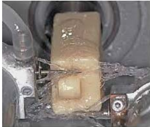
Figura 23 Fresado del bloque con sistema CAD-CAM.
