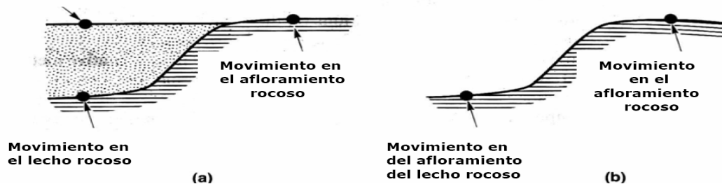
Figura VII.11. Descripción de los términos más comunes utilizados en un modelo de respuesta sísmica del terreno (Kramer, 1996)
