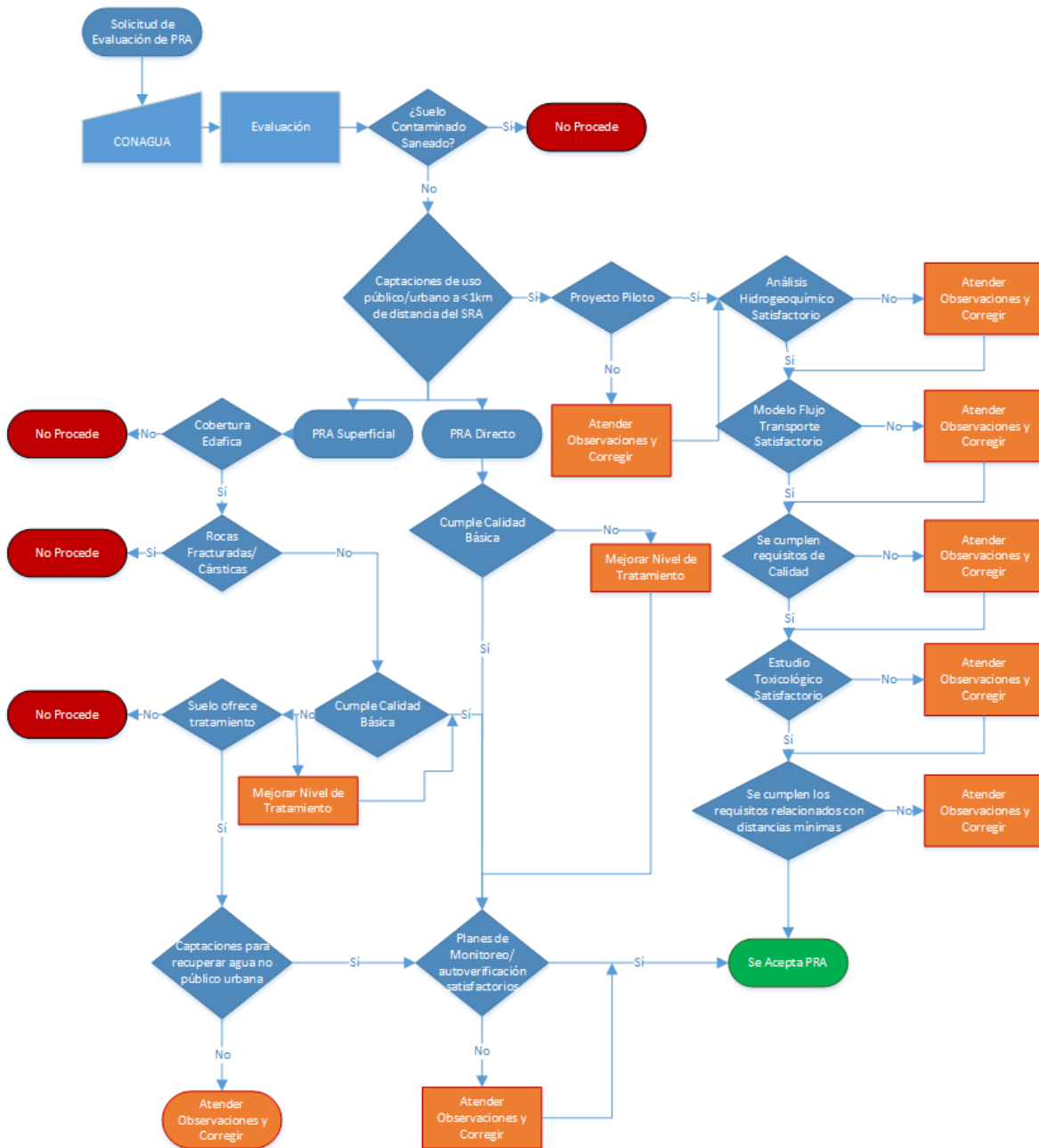
Figura 16. Requisitos para la recarga artificial de acuíferos con agua residual tratada (NOM-014-CONAGUA-2003).
