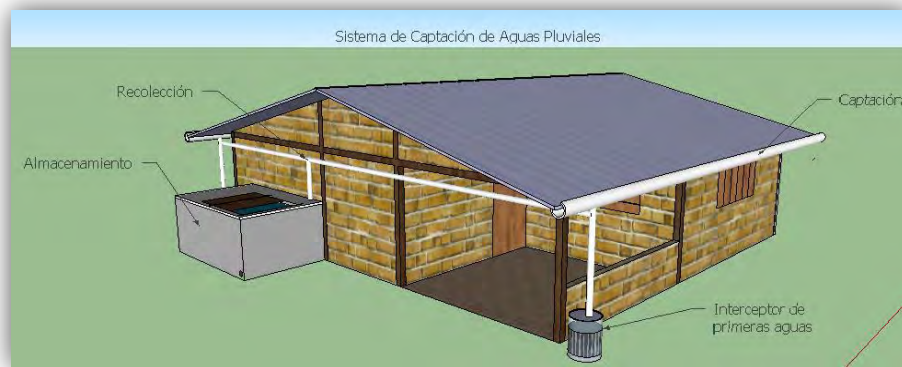
3. Captación de agua pluvial. Sistema de captación con tubos de PVC y almacenamiento de agua de lluvia.
