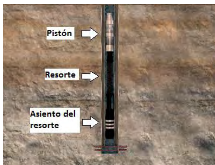
Figura 1.27 Equipo subsuperficial del sistema de Émbolo Viajero. 18
