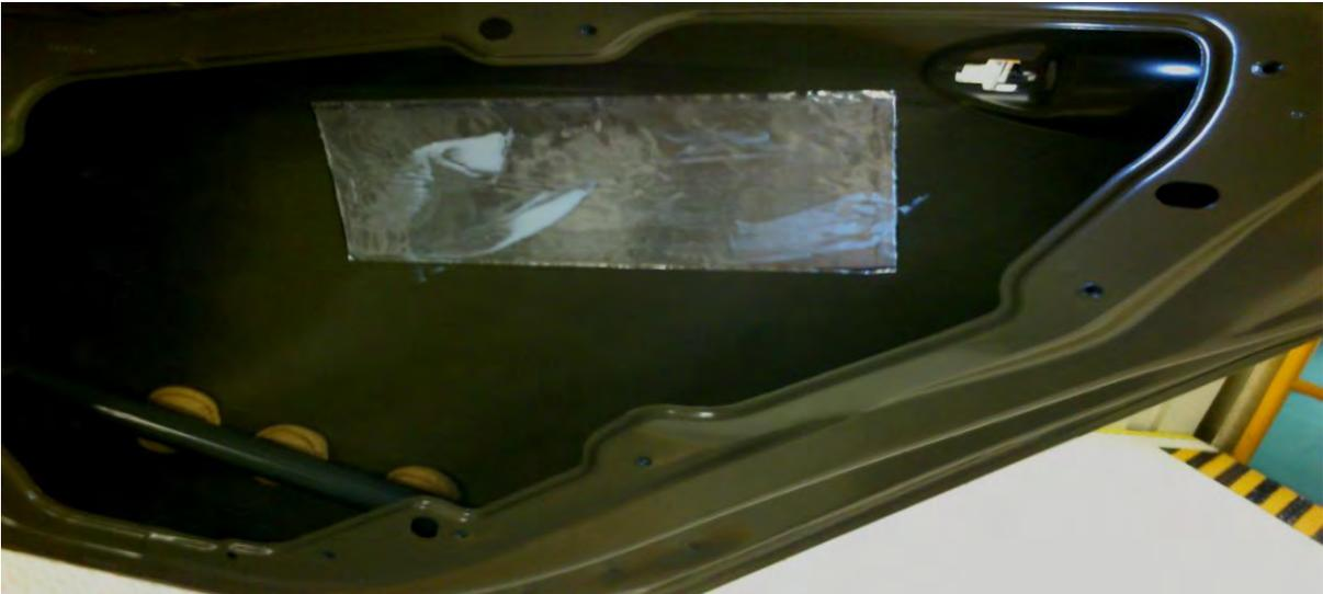
Fig. 23. Tapete antirruído colocado en puerta.
