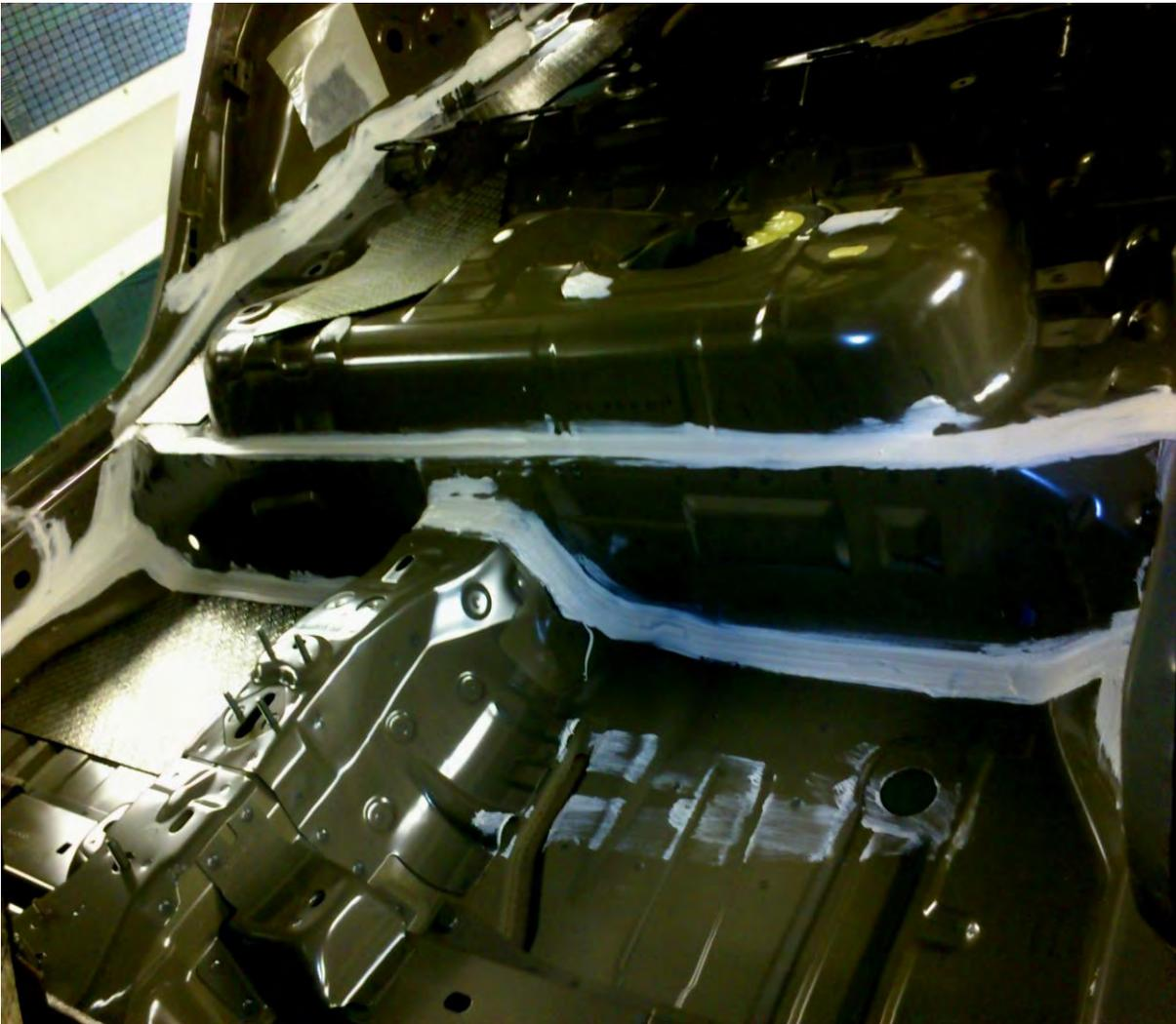
Fig. 19. Sellado de piso trasero y pilar B.
