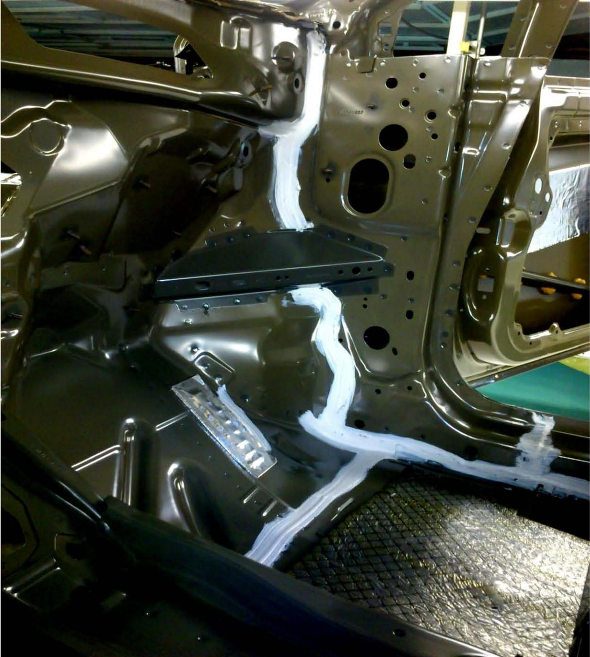
Fig. 18. Sellado de piso delantero y Dash panel.
