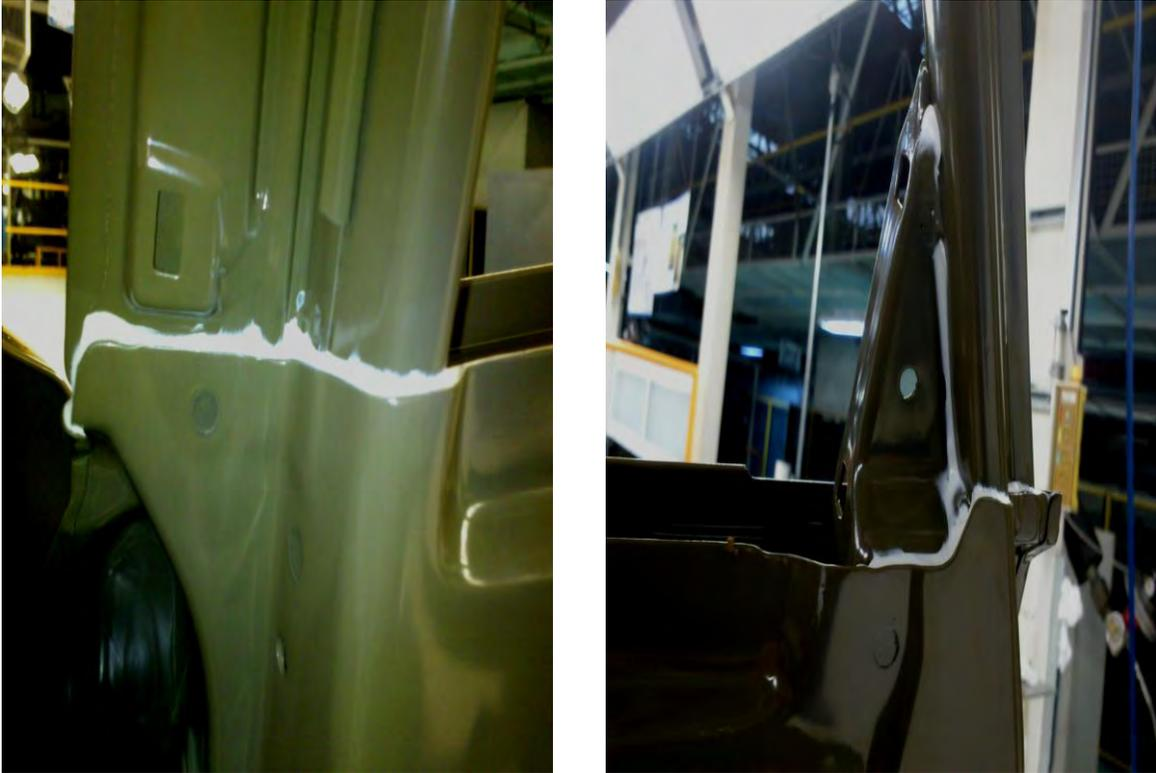
Fig. 27. Sellado de marcos interiores de puerta trasera.
