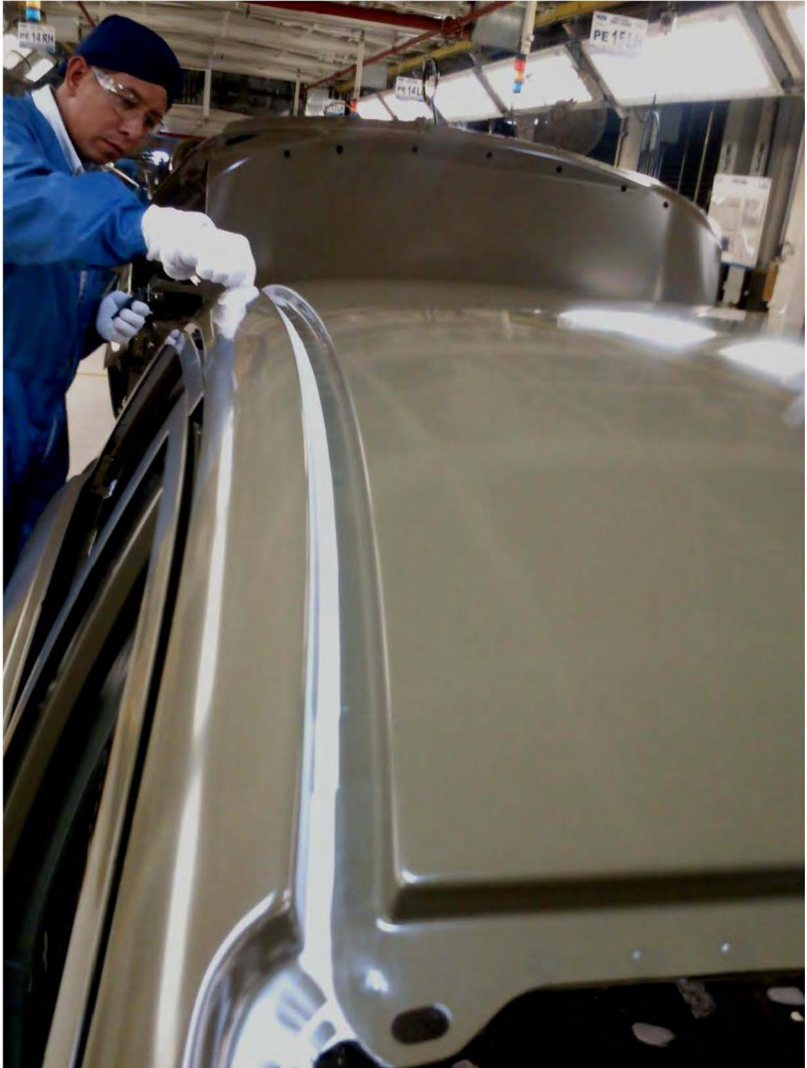
Fig. 28. Acabado con cuña de moldura Ditch.
