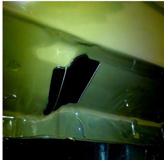
Fig.22. Parche colocado en estribo.
