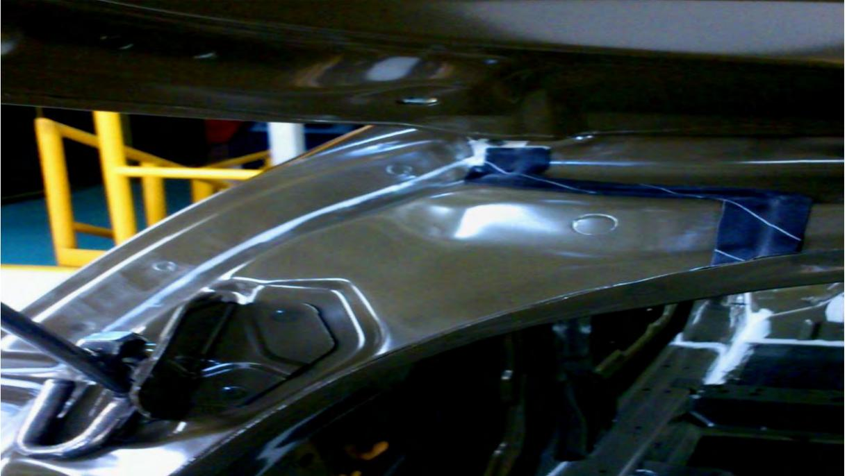
Fig. 29. Sellado de rebajos cajuela de unidades Hatchback.
