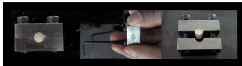
Fig. 43, 44,45 Desalojo del cemento endurecido
