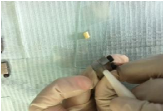
Imagen No.8 Sacando resina del molde
