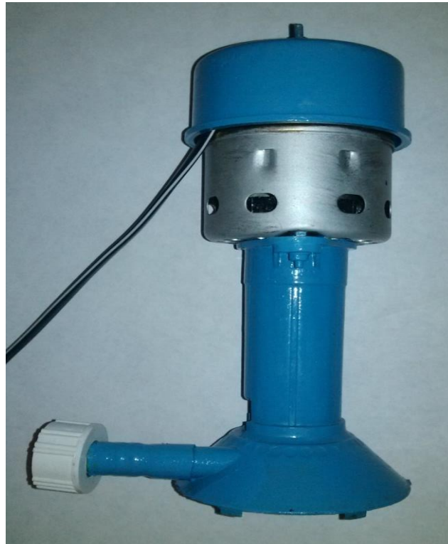
FIGURA 2.29 FOTO BOMBA DE AGUA.
