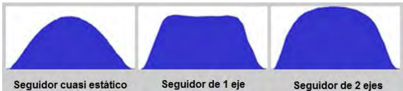
Figura 37. Curvas de generación con y sin seguidores solares.
