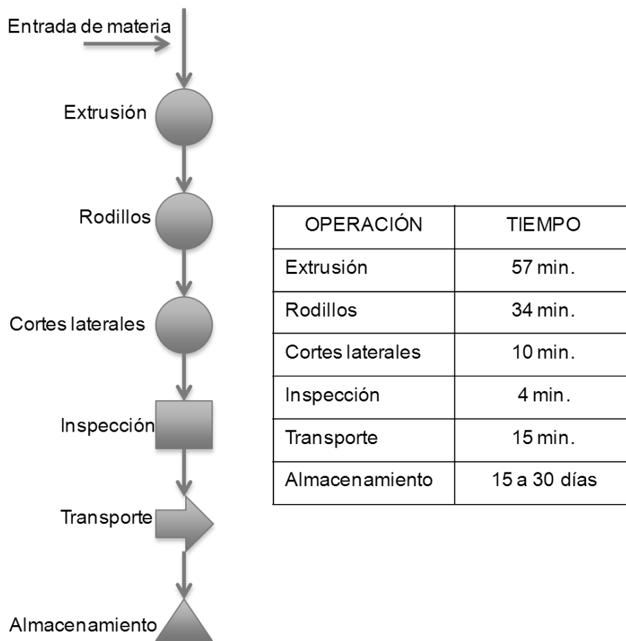
Figura 2.1.5.4. Diagrama de operación de película de PVC por extrusión. (Gil M. & González S., 2013)
