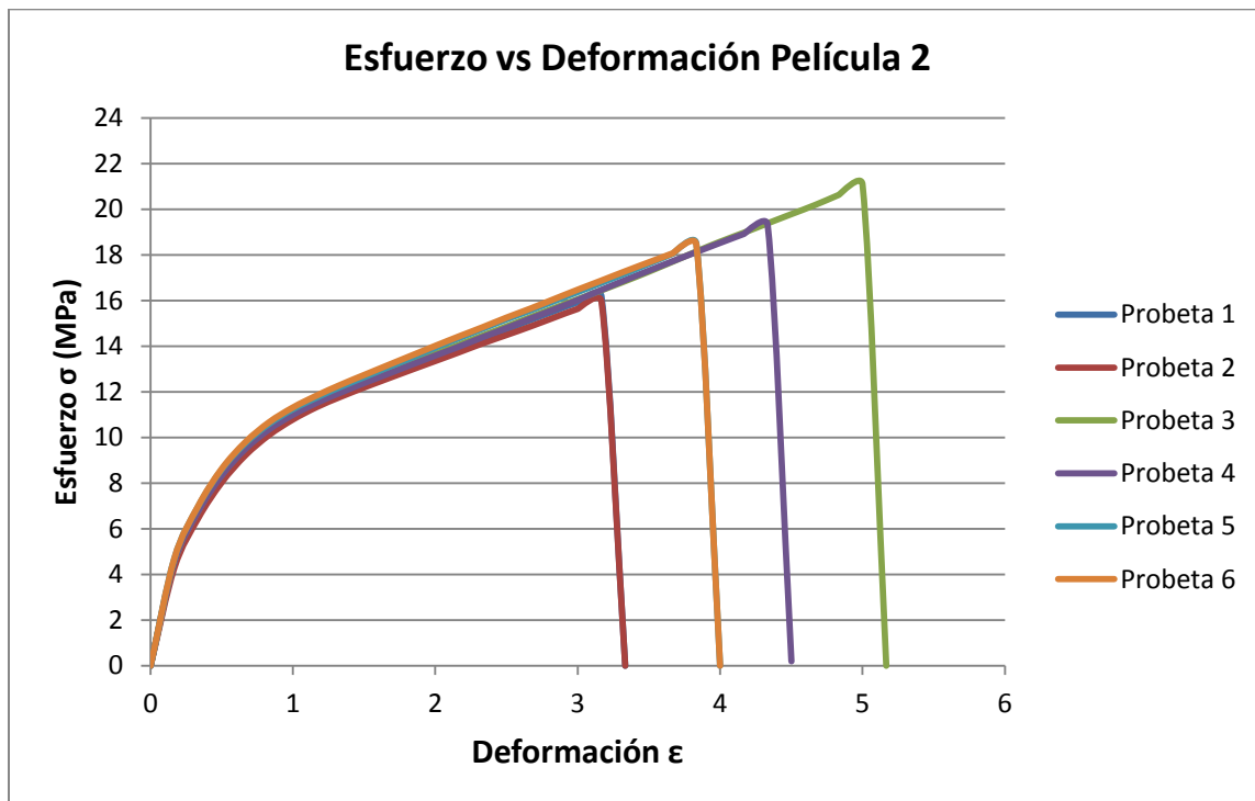
Figura F.8. Gráfica esfuerzo deformación de las probetas dirección máquina de la película 2.
