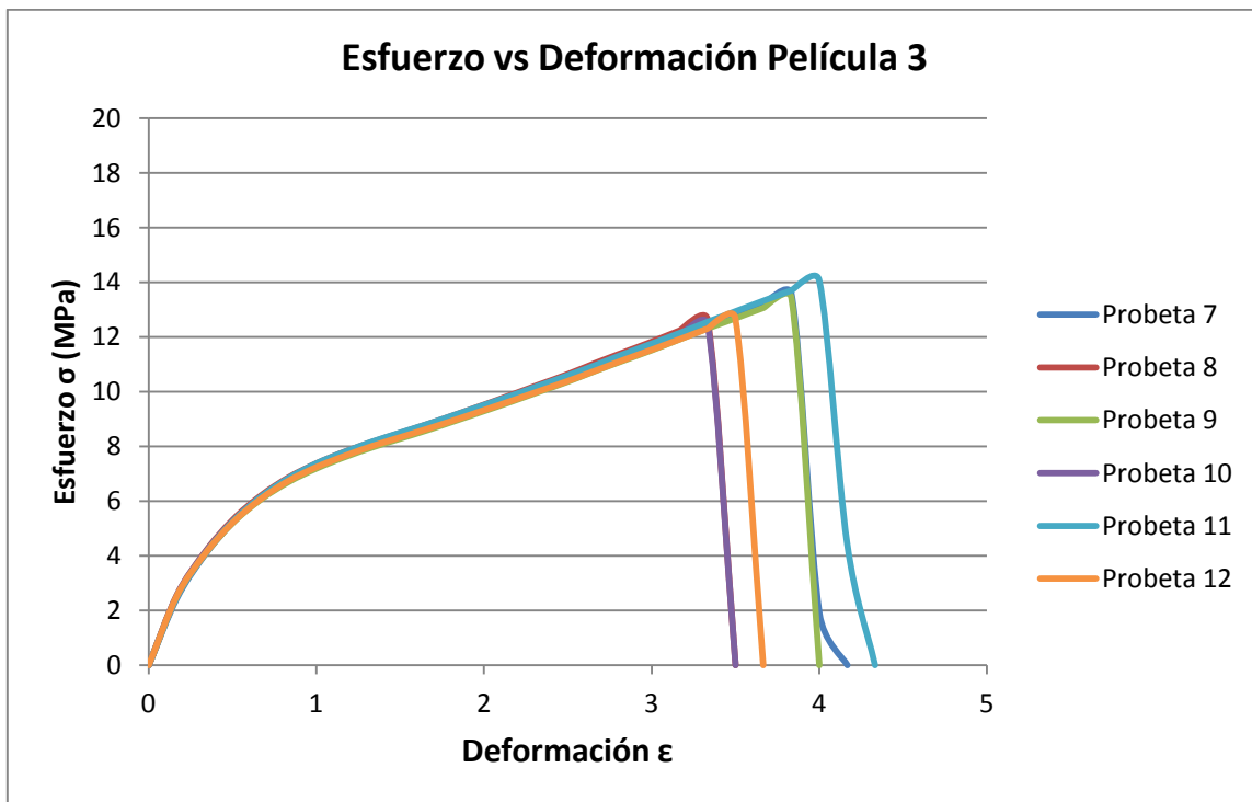
Figura F.12. Gráfica esfuerzo-deformación de las probetas dirección transversal de la película 3.
