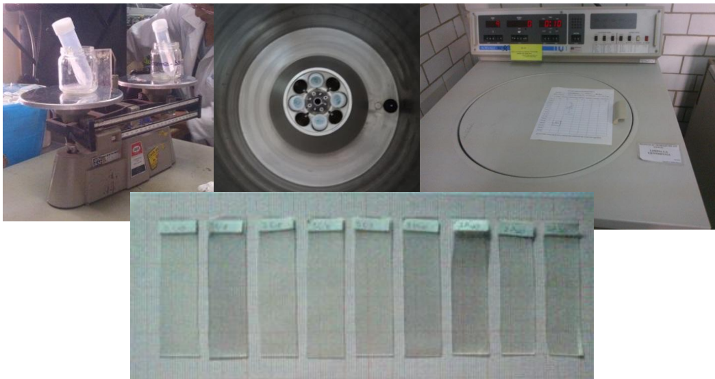
Figura I.5. Centrifuga de alta velocidad Sorvall RC 5C Plus con rotor SS-34 y tiras centrifugadas.
