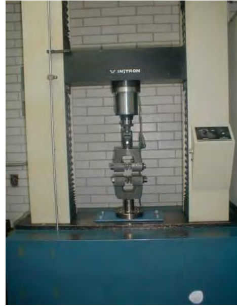
Fig. 30 Colocación de los aditamentos.
