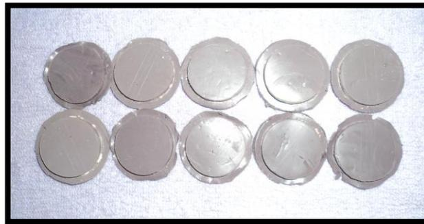
Se realizó el mismo procedimiento al término de 48 horas, se separaron las muestras y se registró la última medición (fig. 7). Obteniendo así tres medidas diferentes tanto en las muestras de hule de polisulfuro como en las muestras de yeso tipo IV.
