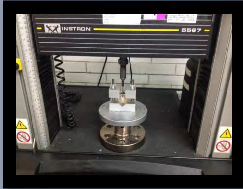
Fig.3 muestra colocada en la maquina universal de pruebas mecánicas INSTRON
