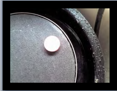
Fig. 3 pulidor metalografico con papel abrasivo
