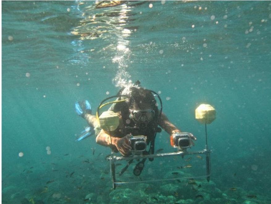
Fig. 11 Sistema estereoscópico montado en un dispositivo acuático. Con ayuda de equipo SCUBA se pueden tomar pares estereoscópicos, en este caso en un ambiente marino.
