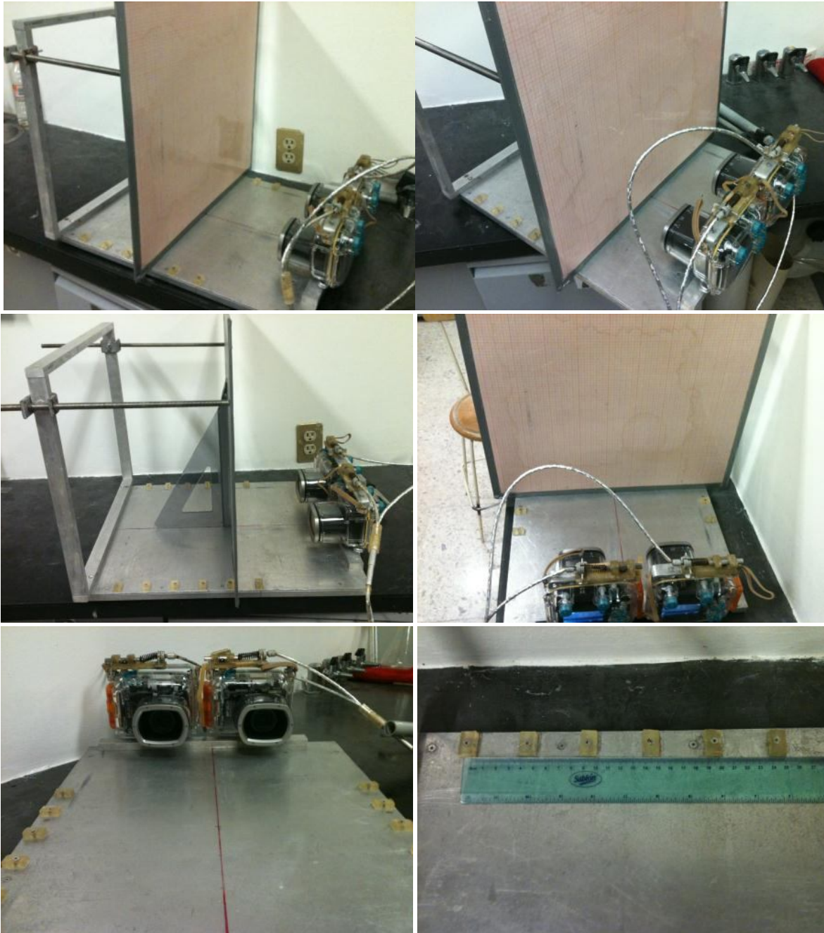
Fig. 15 Sistema estereoscópico de cámaras montado en una placa para la calibración. El sistema estereoscópico tiene la ventaja que puede ser montado en diferentes dispositivos en este caso se montó en la placa de calibración para desarrollar diferentes experimentos.
