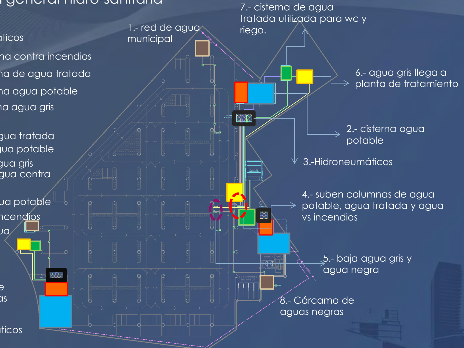
Planta Sótano 6, instalación hidrosanitaria. Imagen realizada por el equipo.
