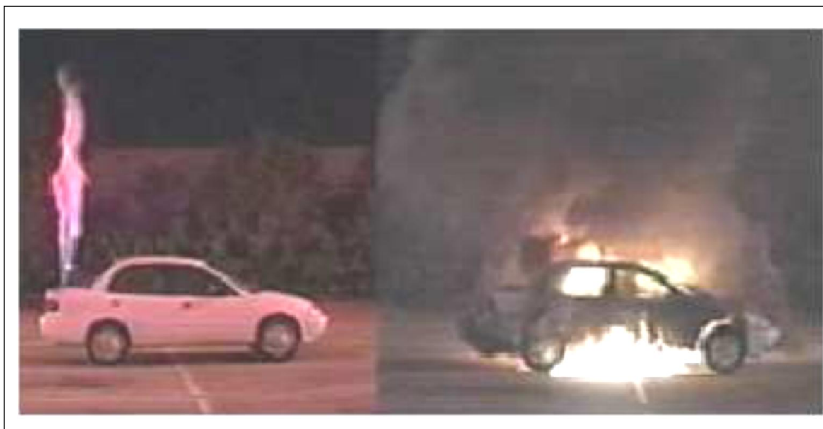
FOTOGRAFÍA 1. PRUEBA DE IGNICIÓN ENTRE DOS AUTOMÓVILES CON USO DE HIDRÓGENO Y GASOLINA.
