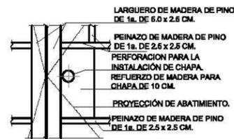
**D3 DETALLE REFUERZO EN BASTIDOR**
