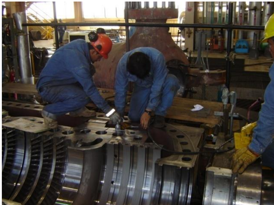
Figura 4.71 Ajuste de carcasa de P.I.
