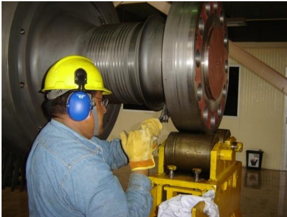
Figura 4.44 Refrescando cuerdas del rotor.
