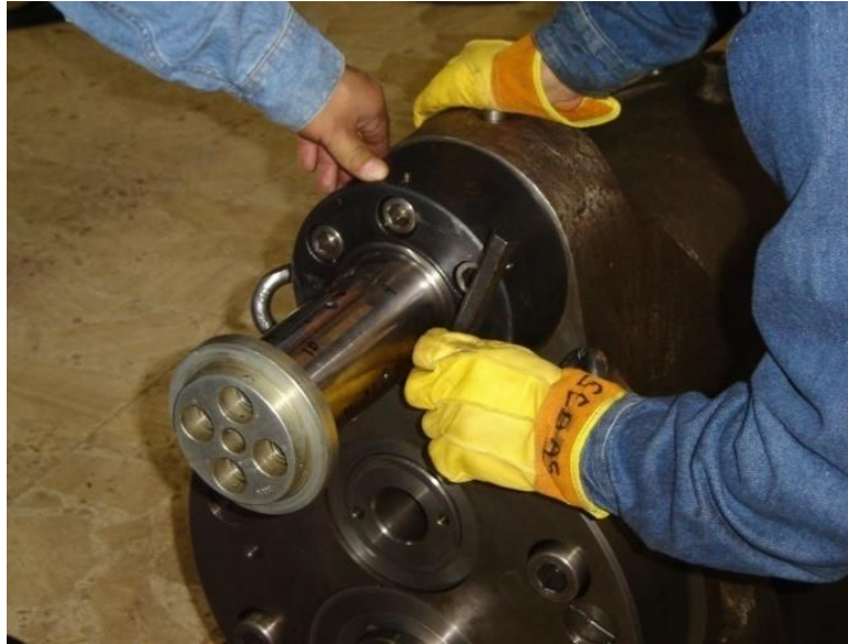
Figura 4.33 Desensamble del mecanismo principal de la bomba de aceite.
