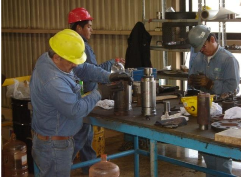
Figura 4.53 Limpieza de pernos de centrado.
