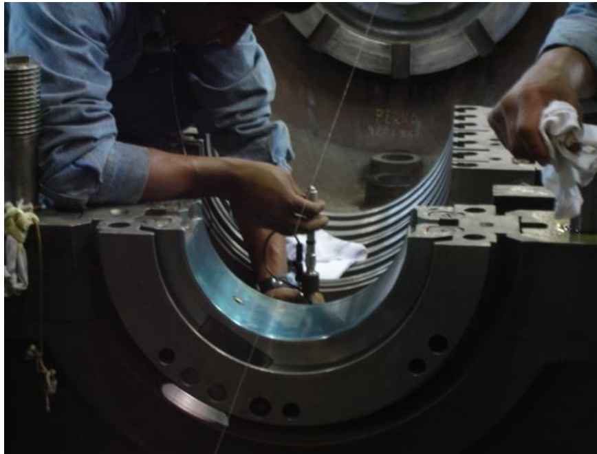
Figura 4.65 Toma de dimensiones de centrado.
