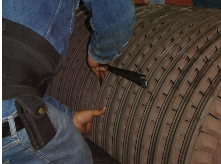
Figura 4.8 Toma de lecturas claros cintillas radiales y carcasa
