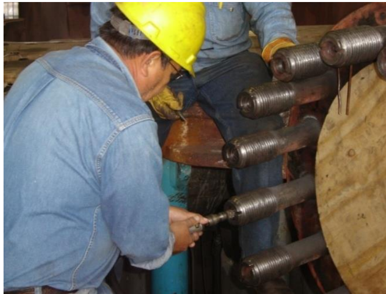
Figura 4.27. Lubricación en tornillería de válvulas de control.
