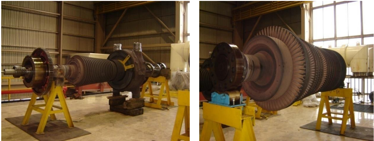
Figura 4.10 Rotores de alta e intermedia presión en sus soportes.
