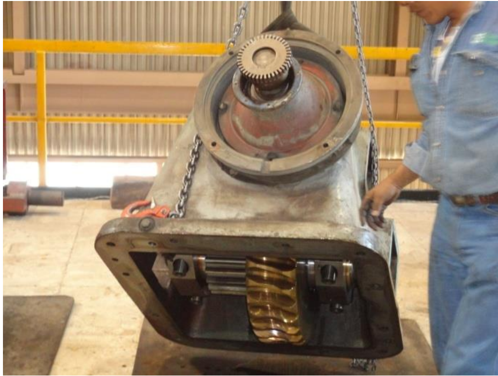
Figura 4.81 Revisión de engrane de la torna- flecha.
