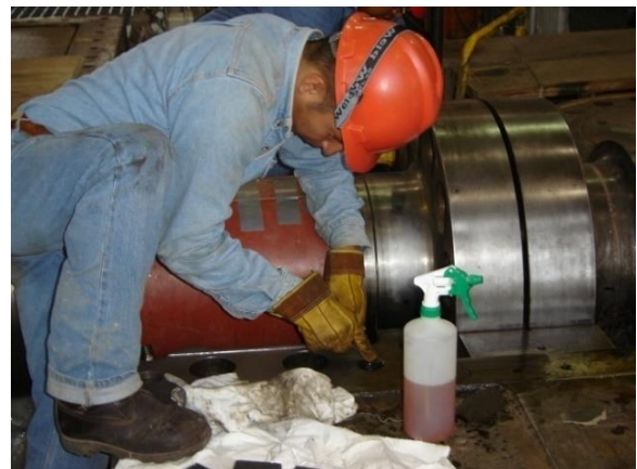
Figura 4.3 Limpieza de las juntas horizontales y verticales.
