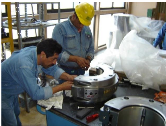
Figura 4.19 Desarmado y limpieza de chumaceras.
