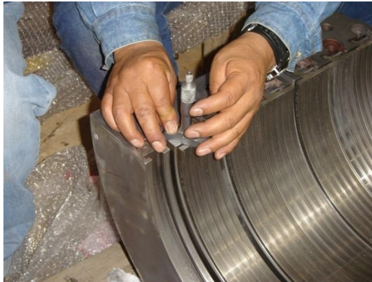
Figura 4.46 Toma de medidas de sellos en empaquetadoras.
