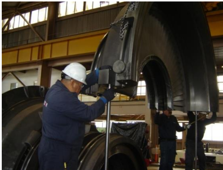
Figura 4.56 Colocación y toma de lectura de porta-alabes.
