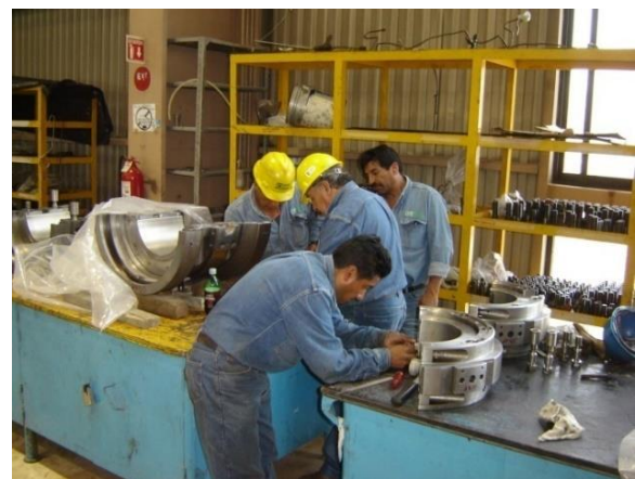
Figura 4.19 Desarmado y limpieza de chumaceras.
