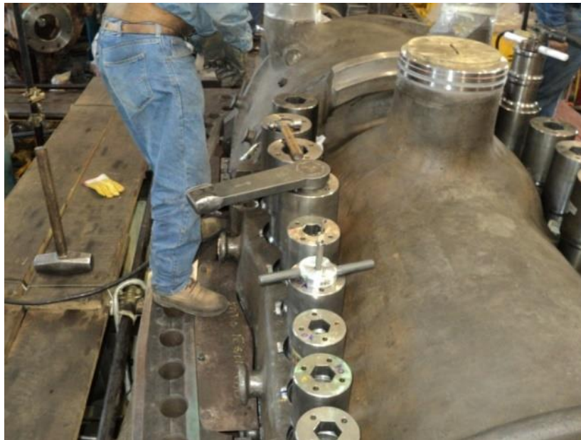
Figura 4.78 Apriete de birlos en carcasa de A.P.
