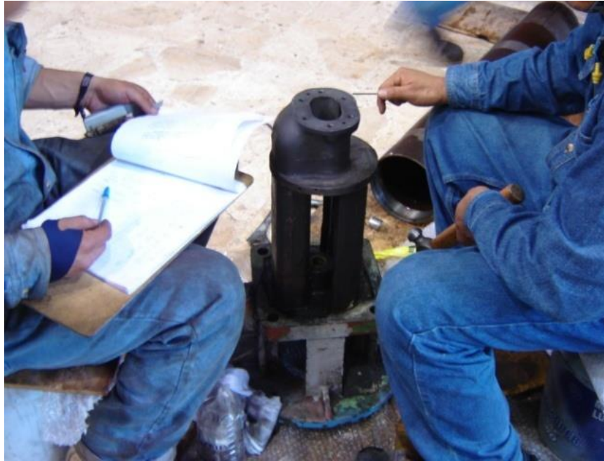
Figura 4.64 Desensamble de bomba presión intermedia.
