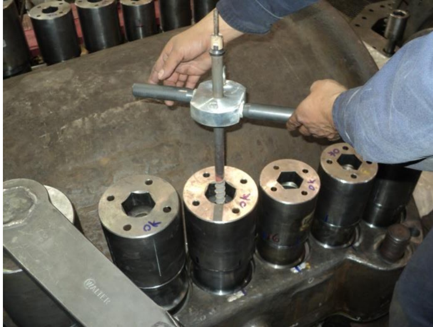
Figura 4.79 Resistencia utilizada para apriete con calor.
