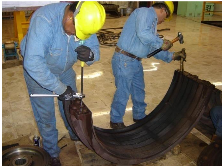
Figura 4.34 Retiro de sellos de las empaquetadoras.
