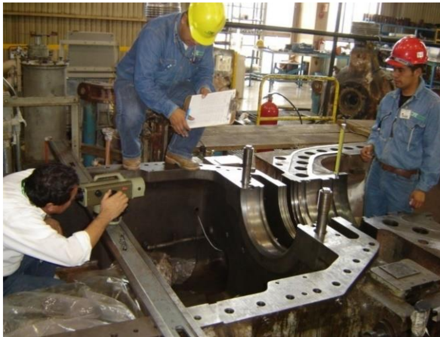
Figura 4.42 Toma de altimetría.
