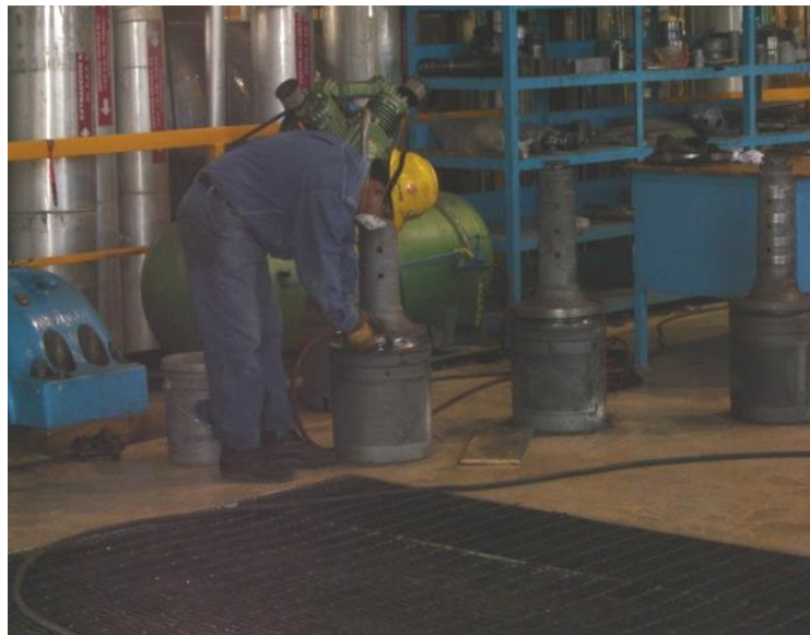
Figura 4.30 Limpieza de filtros y cuerpos de válvulas.
