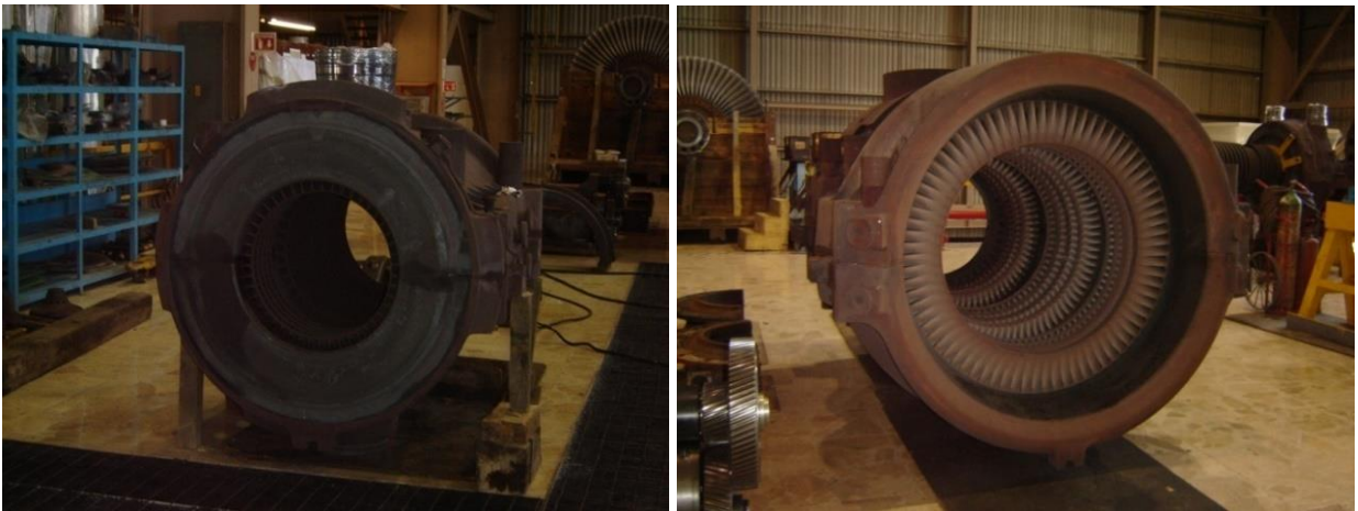
Figura 4.14 Se observan los porta alabes de intermedia y alta retirados.
