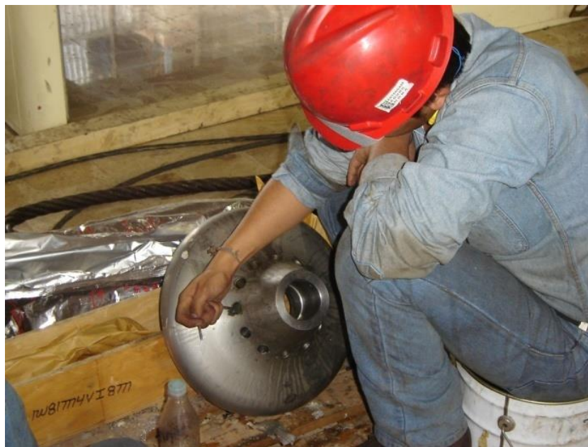
Figura 4.25 Limpieza en los asientos móviles.
