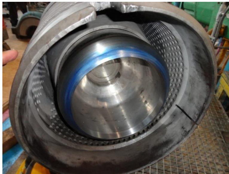
Figura 4.32 Prueba de contacto a válvula "B"
