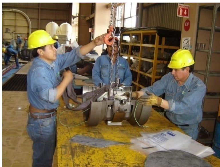
Figura 4.11 Limpieza de componentes de chumacera 2.
