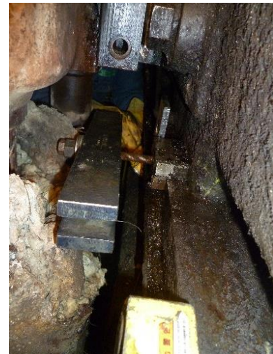
Figura 4.62 Retiro de guías axiales de pedestal chumacera núm. 2 lado gobernador.
