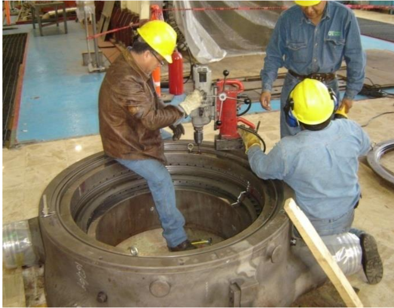
Figura 4.45 Preparación de tobera de admisión de vapor.
