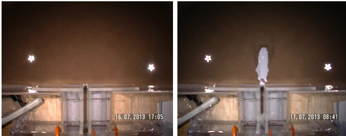
Figura 5.13: Izq. Distribución de partículas en el sistema e estudio. Izq. A los 30 segundos de simulación. Der. Después de 15 horas.
