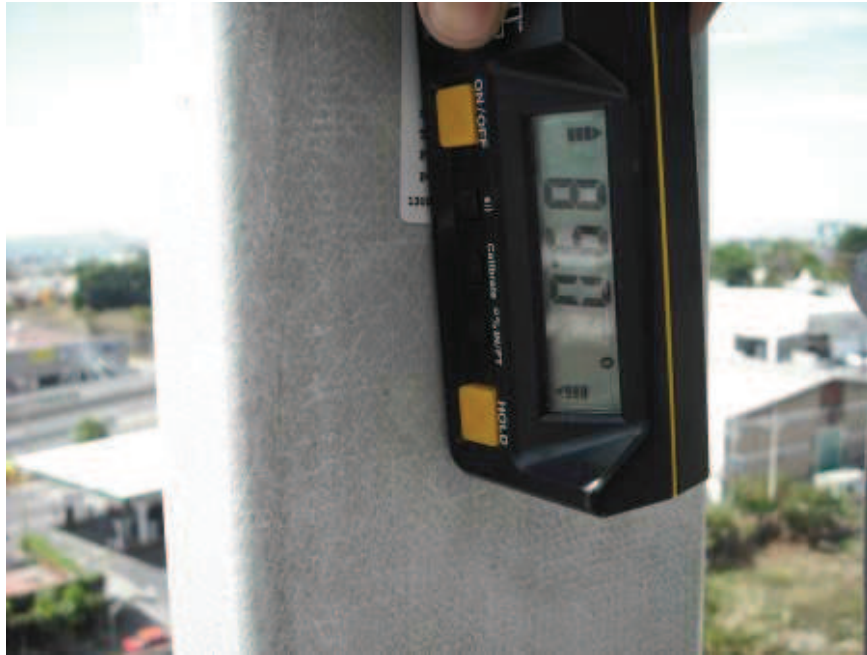
Figura 4.14 Medición de la inclinación mecánica.
