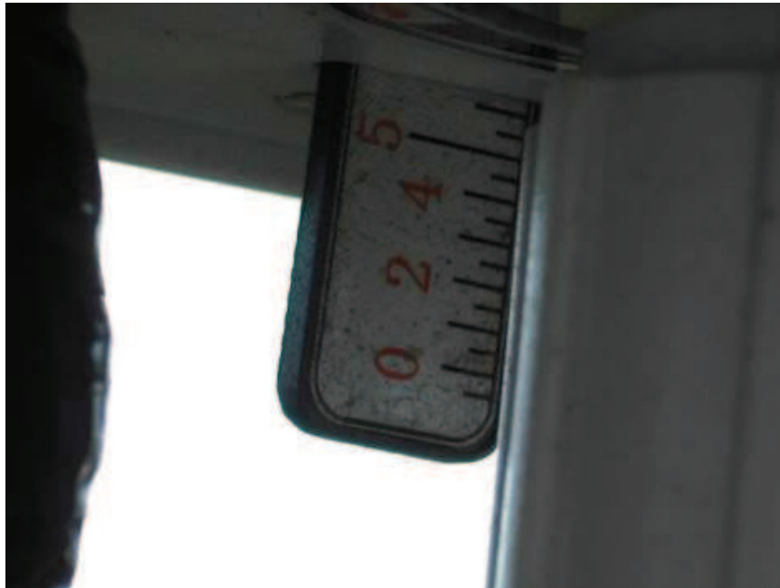
Figura 4.35 Regla para ver la variación de inclinación.
