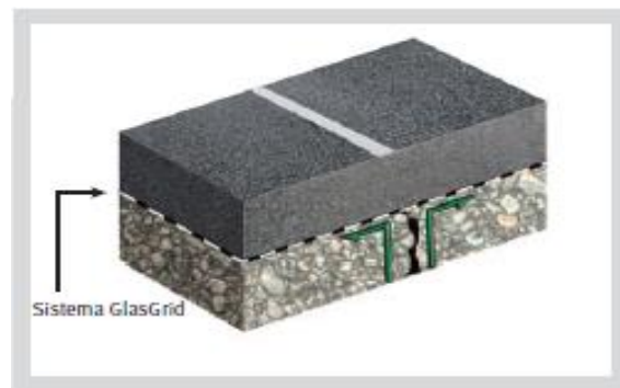
Figura 1.14 Las grietas se reorientan con la sobrecarpeta reforzada con Glassgrid.
