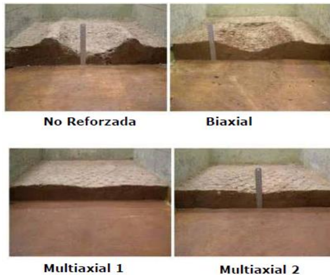
Figura 1.8. Reforzamiento de la subrasante con geomalla biaxial y Triax.
