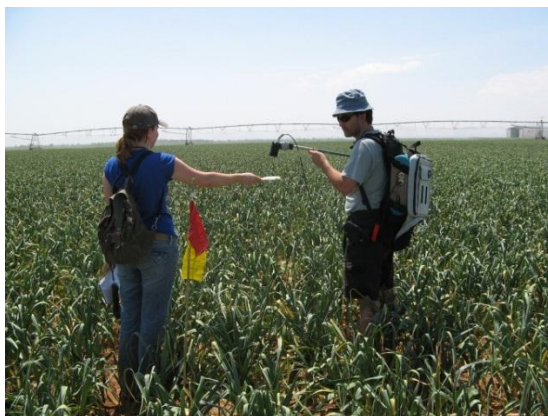
Fig 19. Obtención de respuestas espectrales a partir de un radiómetro de campo ASD Fieldspec 3 (Fuente: INTA)
