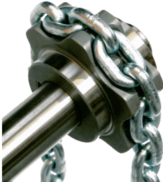
Imagen 8.- Piñón de cadena convencional. Solo cada dos eslabones de la cadena se acoplan en un bolsillo.
