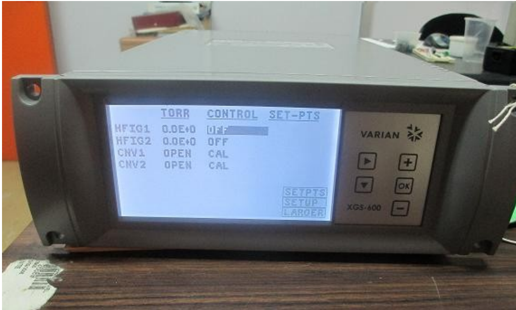
Figura 69: Medidor de vacío que se conecta al esclavo tipo 1
