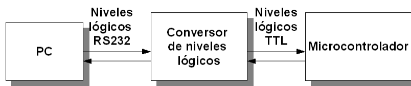
Figura 13: Implementación de una comunicación RS-232
