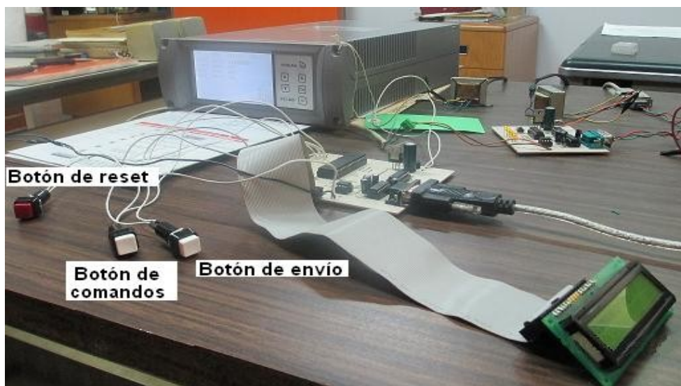
Figura 70: Medidor adjunto al dispositivo esclavo
