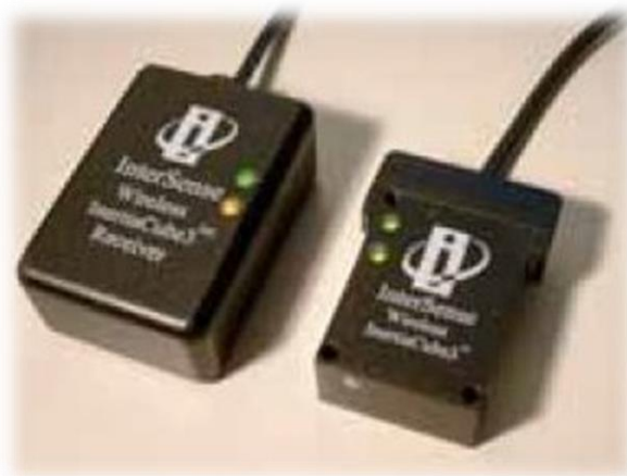
Figura 2.4 Wireless InertiaCube3 (derecha) y su receptor (izquierda). Figura reproducida de [4].
