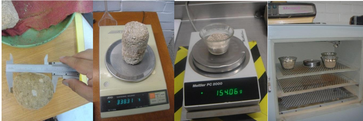
Fig. 40. Procedimiento para obtener el Peso Específico y el Contenido de Agua.
