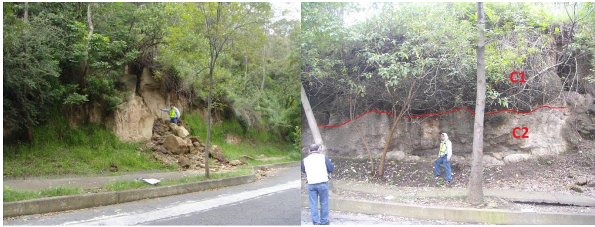
Fig. 26. a) Zona con los primeros bloques desprendidos y donde comienza la concavidad, es la unidad C3. b) Se marcan las unidades C1 y C2 donde termina la concavidad.
