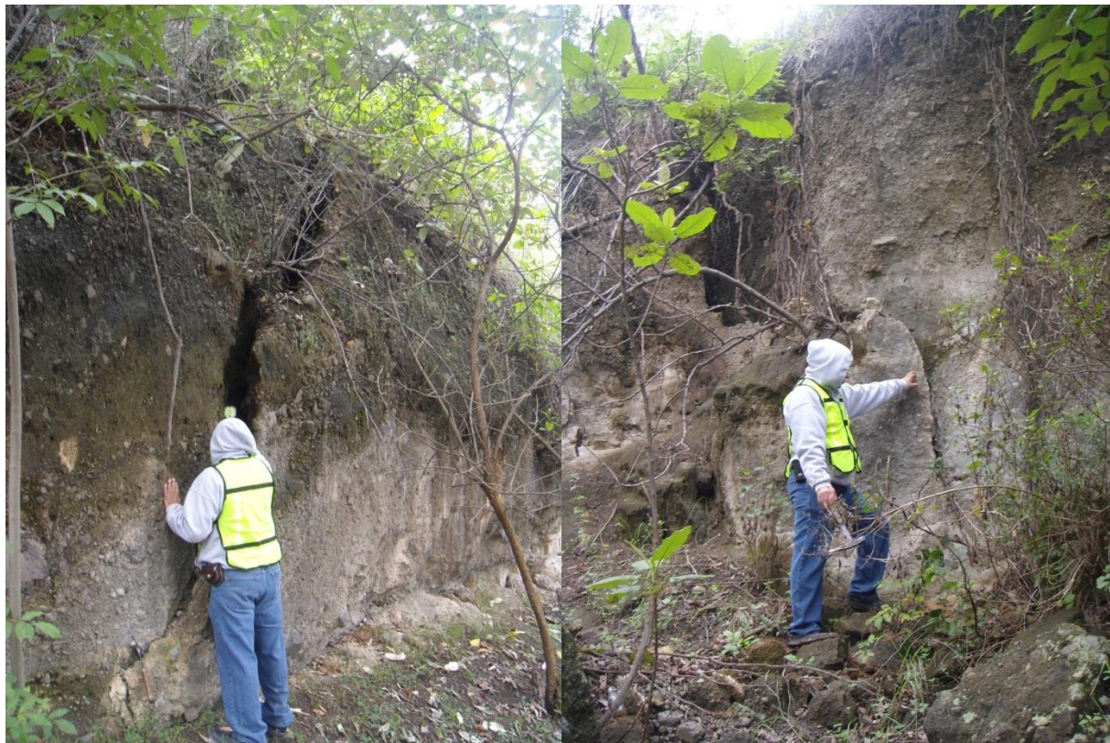
Fig. 55. Parte del mapa estructural que muestra un bloque en cuña del talud Caídos de 50 m 3 . La imagen muestra las discontinuidades que lo delimitan (vistas desde el norte sobre la banqueta).
