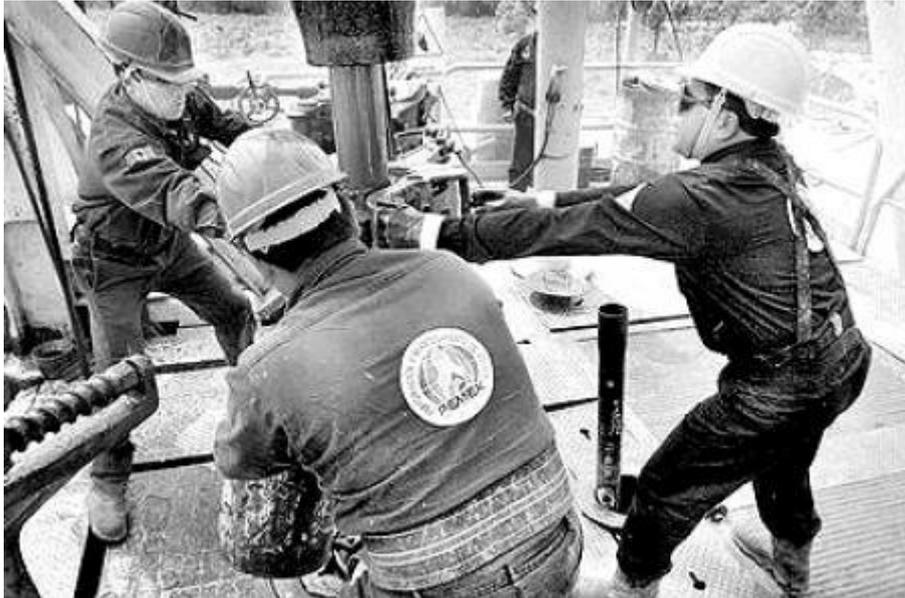
*Figura 3.5, Operación de cambio de tubería*
