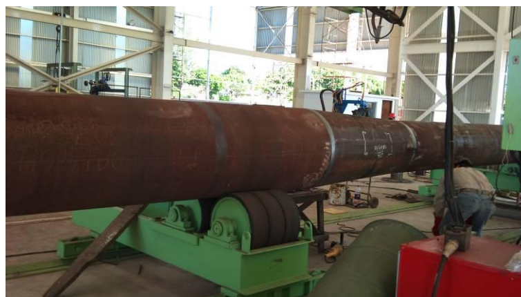
Fig. 2.2.2.- Fabricación de un pilote en taller.
