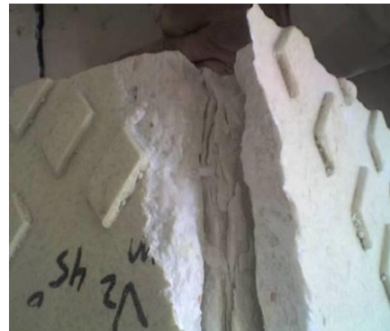
Figura 8.3 A y 8.3 B En las siguientes fotografías el desprendimiento del material se ve el desprendimiento del material en capas.
