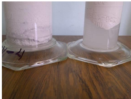
Fig.6.11 Foto correspondientes al término de 3 días lado izquierdo Microsil 100S, lado derecho Microsli 200S.
