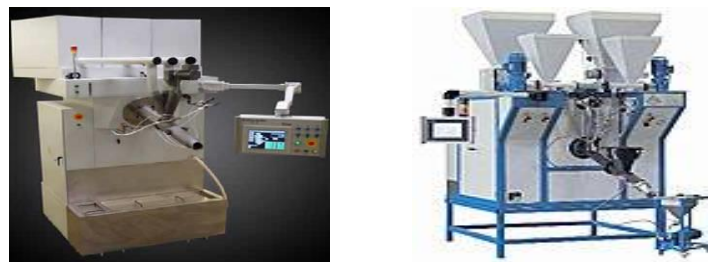
Fig. 2.4 Lado izquierdo equipo Autocaster Polymer Concrete (Globmarble LLC);lado derecho mezclador y dispensador volumétrico (ADM Isoblock).
