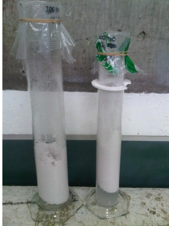
Fig. 6.12 A finalizar la prueba 7 días Se absorbe el agua y se forma una pasta.
