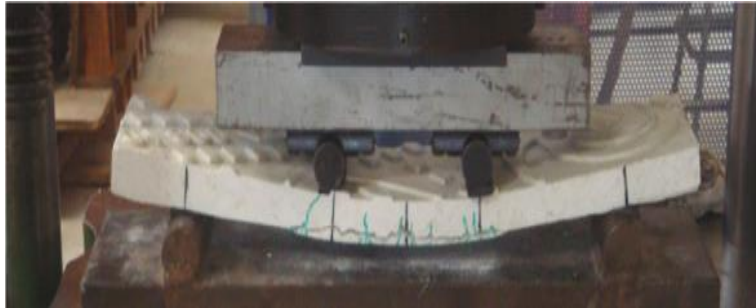
Figura 8.2 Muestra las fallas por flexión en fibras de 45°.
