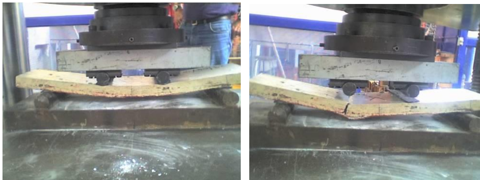
Figura 7.5 Ensayo a flexión de placa de concreto polimérico reforzado con petatillo. Obsérvese la gran deflexión que sufre antes de producirse la fractura prácticamente en el punto de aplicación de carga.
