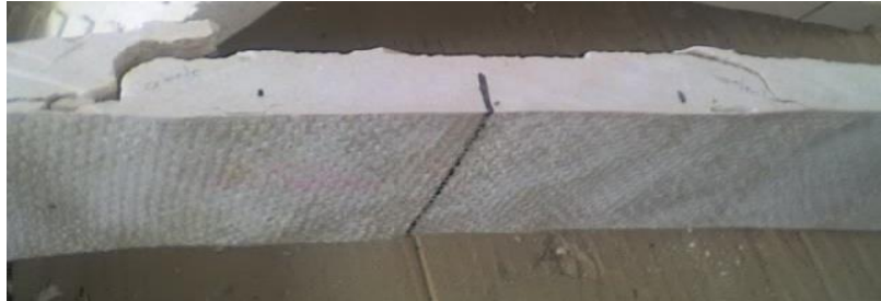
Figura 8.5 Muestra fallas orientadas a 0°, que se inician con fallas por flexión.
