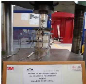
Fig. 4.1 Ensayo de cilindros.
