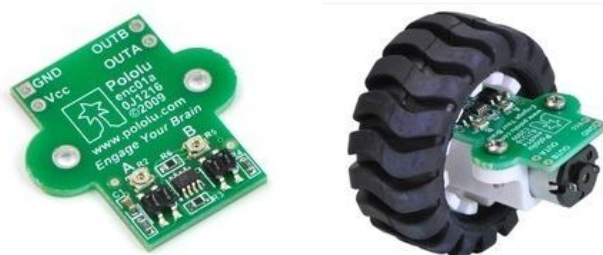
Figura 3.28. Encóder y llanta fija utilizada en el robot móvil.
