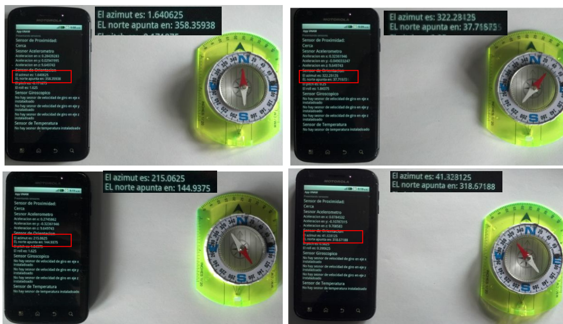
Figura 4.5. Comparación entre una brújula analógica y el sensor de orientación del modelo Motorola MB860.
