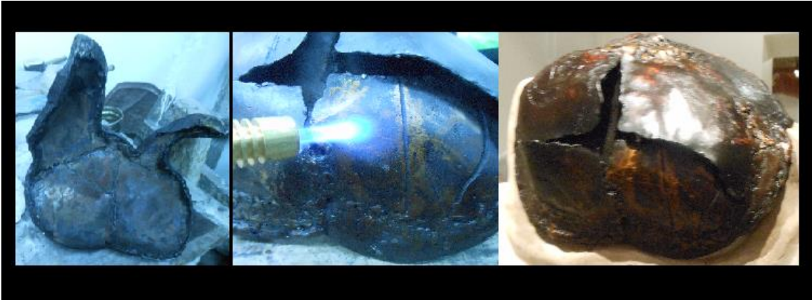
Imágenes de la pieza forjada con aplicación de calor para consolidar la pátina.
