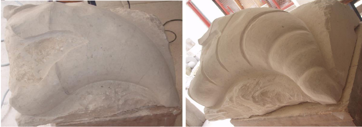
Imágenes de la pieza tallada en mármol, proceso de desbaste con esmeril, copa y cortes en V.
