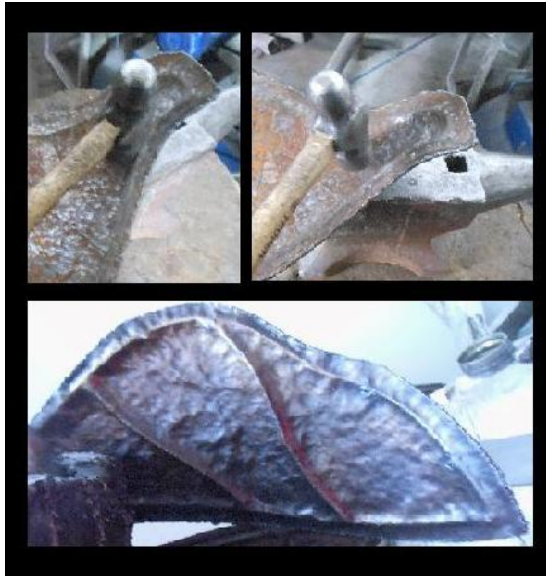
Imágenes del proceso de forja y ala forjada.
