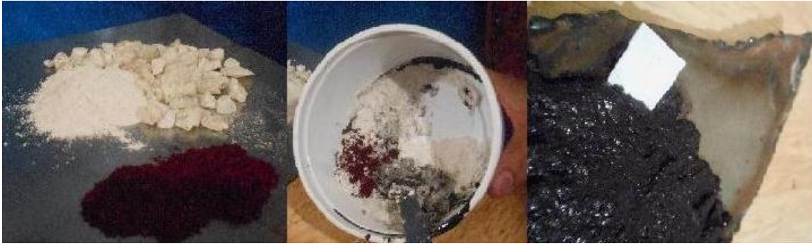
Mármol triturado y en polvo, pigmento mineral, mezcla y revestimiento de la pieza metálica.
