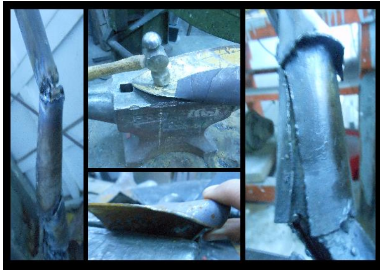
Imagen del proceso de forja para revestir el tubo.
