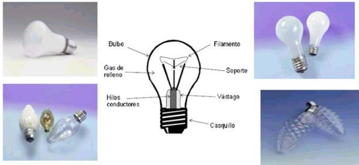
**Figura 31 COMPONENTES DE UNA LÁMPARA INCANDESCENTE**
