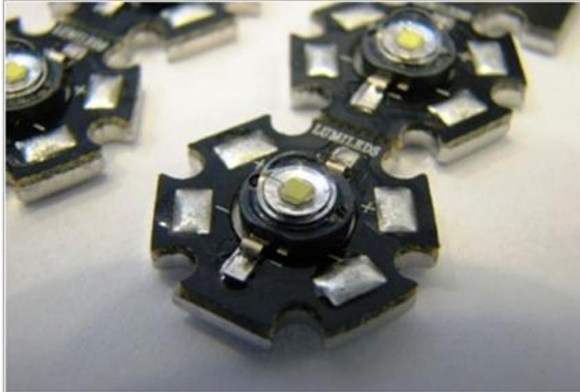
**Figura 19 LED DE ALTA POTENCIA**
