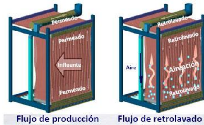
Figura 2.21 – Retrolavado de las membranas ZeeWeed. (Peeters, 2008)
