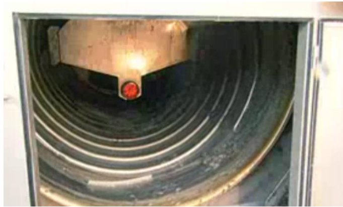
Figura 2.11 – Interior de rejillas finas de tambor rotativo. (Parkson, 2010)
